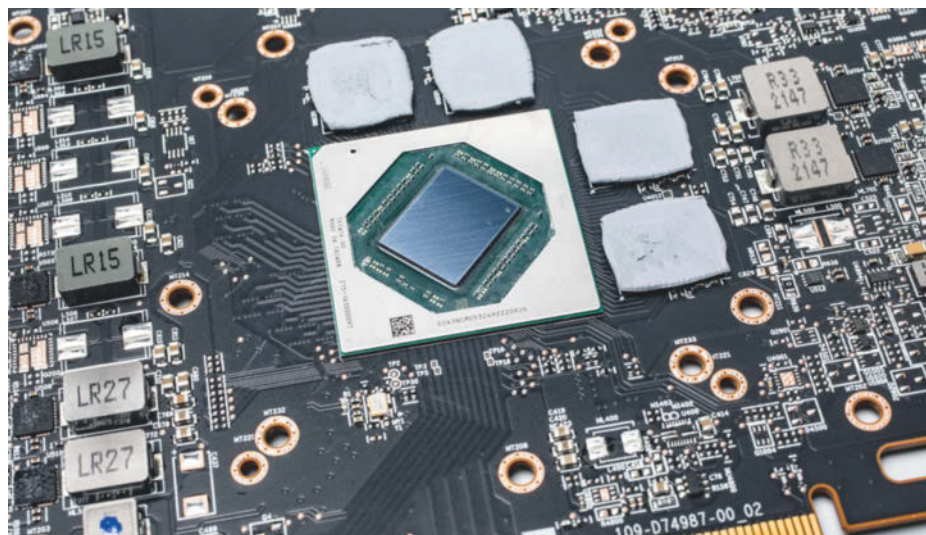
Der kleine Navi33-Grafikchip (Bildmitte) sorgt auf Radeon Pro W7500 und W7600 für die nötige Rechenleistung.
