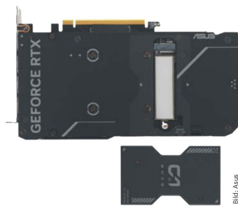
Den M.2-Slot für eine SSD versteckt Asus auf der Rückseite Dual RTX 4060 Ti SSD unter einer verschraubten Abdeckung.
