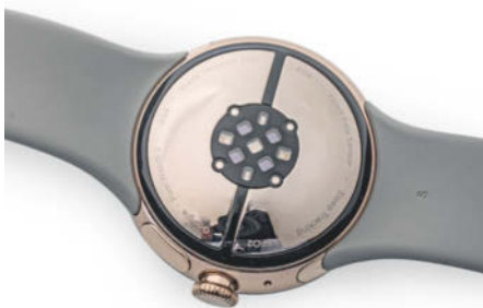
An der Unterseite der Smartwatch sitzen Sensoren, die unter anderem die Pulsfrequenz, die Blutsauerstoffsättigung und die Hauttemperatur messen.
