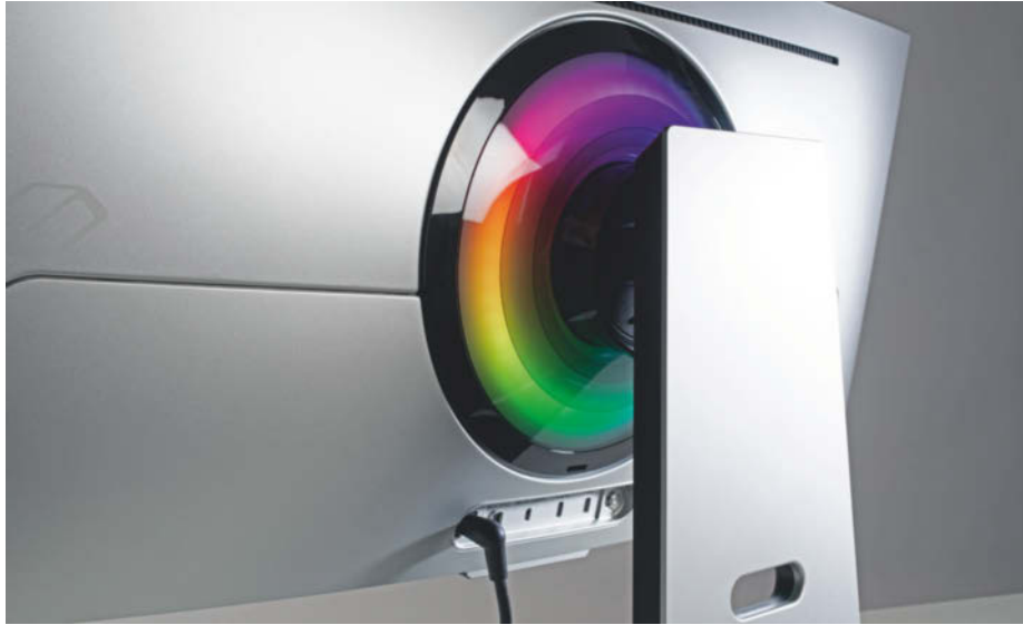
Leuchtrücken: In beinahe allen OLED-Monitoren liefern in die Rückseite eingesetzte RGB-LEDs eine auf Wunsch abschaltbare Lichtshow. Im Bild: Samsungs Farbkarussell.
