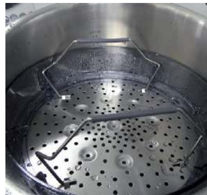
Eingelaufen. Der Kunststoffring des Kenwood-Dampfgareinsatzes schrumpft bei der ersten Nutzung, der Einsatz rutscht in die Schüssel.
