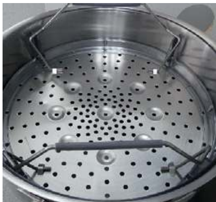
Eingelaufen. Der Kunststoffring des Kenwood-Dampfgareinsatzes schrumpft bei der ersten Nutzung, der Einsatz rutscht in die Schüssel.
