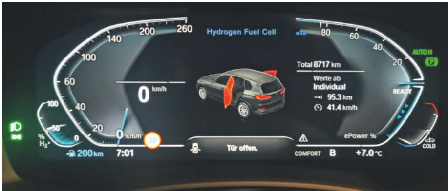
Das Kombiinstrument des BMW iX5 Hydrogen zeigt unten rechts die Temperatur der Brennstoffzelle.
