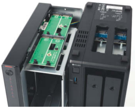
Das Asustor AS5402T (links) nimmt bis zu vier M.2-SSDs auf, muss aber aufgeschraubt werden. Zwei Klappen im Boden des Synology DS723+ machen das Cache-Bestücken leicht.
