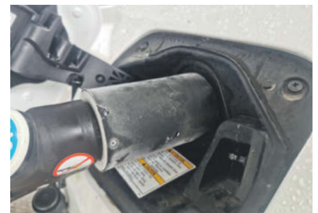
Nur am Griff anfassen: Der Tankstutzen kühlt so sehr ab, dass sich binnen Sekunden Reif daran bildet.
