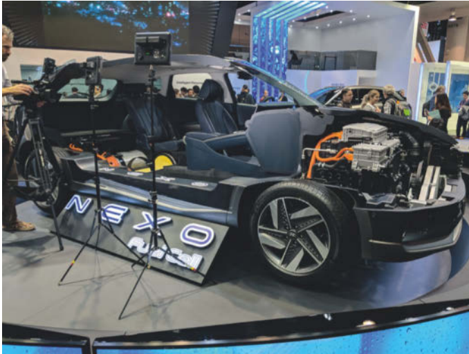
Der Hyundai Nexo lagert die Wasserstofftanks gut geschützt unter den Rücksitzen.
