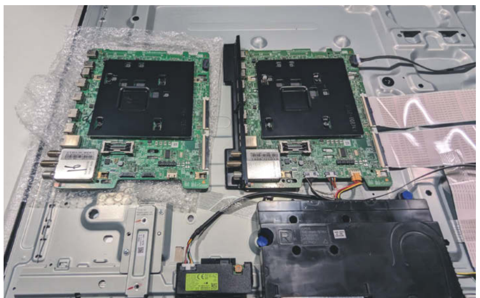
Sichtprüfung bestanden: Die Komponenten und Anschlüsse des Ersatz-Mainboards stimmen mit denen des Originalbauteils überein.
