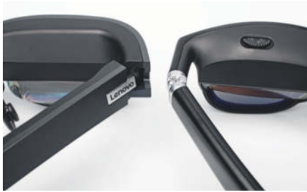
Die Viture One (rechts) hat Rädchen, um Dioptrien ohne Zusatzgerät direkt einzustellen. Ihre Gelenke sind auch weniger scharfkantig.
