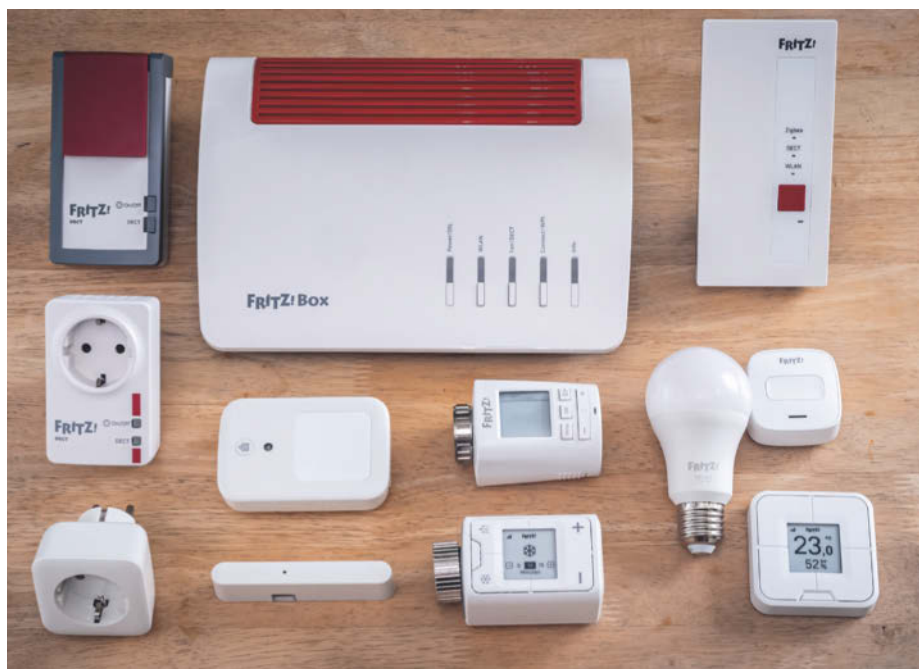
Das Smart-Home-System von AVM samt der gezeigten Telekom-DECT-Komponenten lässt sich komplett offline betreiben – selbst wenn die Hersteller verschwinden sollten.
