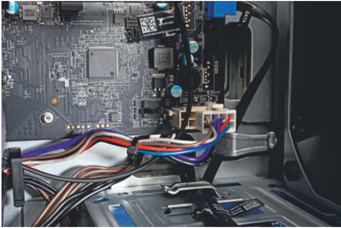
Dell verwendet im Alienware Aurora R16 ein Netzteil und Mainboard mit 12-Volt-only-Technik und proprietären Steckern.
