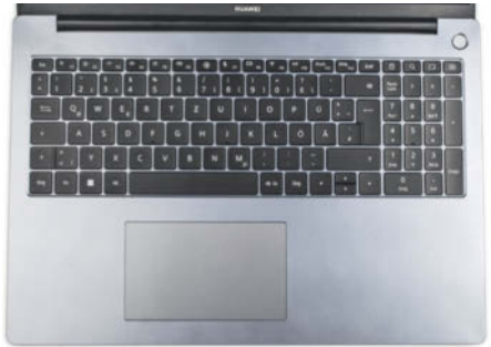
Die beleuchtete Tastatur bietet einen vierspaltigen Ziffernblock; die F-Tasten sind ab F7 um eine Taste nach rechts versetzt.
