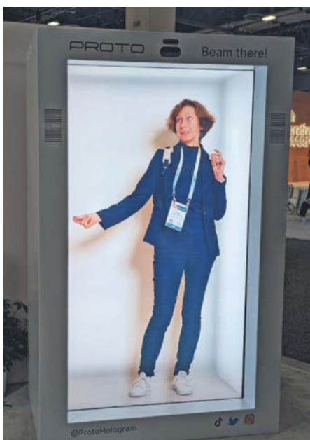
Die Holobox von Holoconnect erzielt die 3D-Darstellung auf dem 2D-Front-LCD durch geschickten Schattenwurf.
