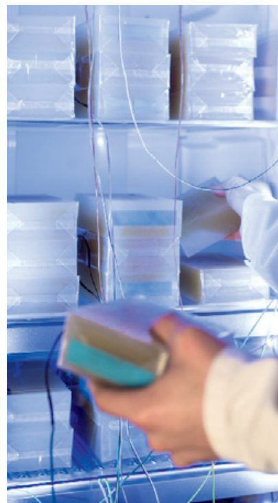
Einheitskühlgut. In den verkabelten Kühlpaketen stecken Sensoren, die die Temperatur erfassen.
