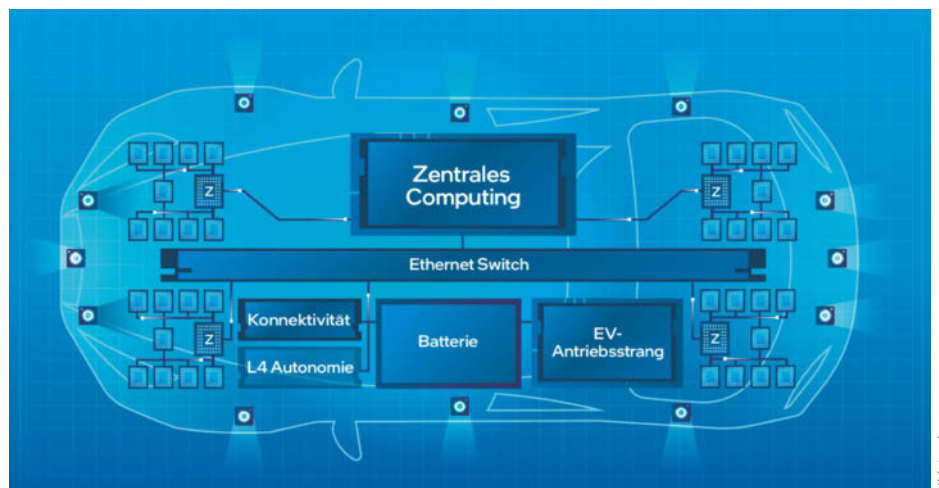
Wie Intel in einer Broschüre aufzeigt, sollen künftige Fahrzeuge deutlich weniger Steuergeräte aufweisen. Sensoren und Aktoren werden über ein Hochgeschwindigkeits-Ethernet Backbone zentral angebunden.
