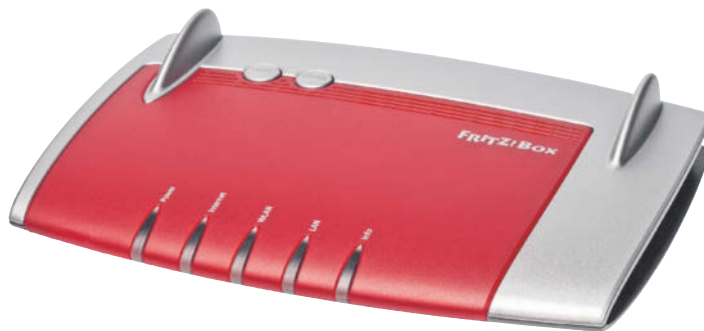
Die Fritzbox 4040 wird aufgrund ihres vergleichsweise potenten Prozessors gerne genutzt. Die WireGuard-Einführung bei Gluon hat ihr einen Schub in den dreistelligen Mbit-Bereich verpasst.
