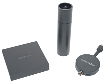
Drei Nachrüstsets für drei Typen: Nokias 8010 (links) punktet mit der praktischen Fernbedienung, Waipus Hybrid-Stick (rechts) versteht sich auf DVB-T2 und Nvidias Shield (Mitte) integriert das TV perfekt ins Kodi-Mediacenter.
