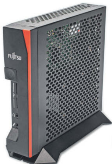
Fujitsus Futro-Thin-Client-Reihe ist bei Freifunkern besonders beliebt, weil man sie kostengünstig auf Gebrauchtmärkten erstehen und leicht zum Offloader umbasteln kann.
