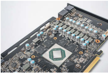
Nicht nur die 16 GByte der Radeon RX 7600 XT mit monolithischem Navi33-Grafikchip, sondern auch höhere Taktraten erfordern bei allen Karten einen zweiten Stromanschluss.
