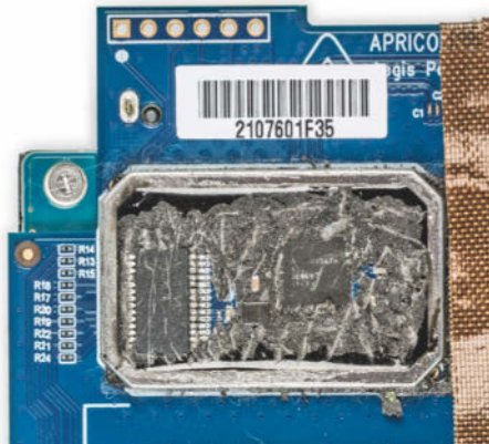
Beim Freilegen der Chips der Apricorn-Festplatte kamen unter dem Epoxidharz interessante Chips zum Vorschein.
