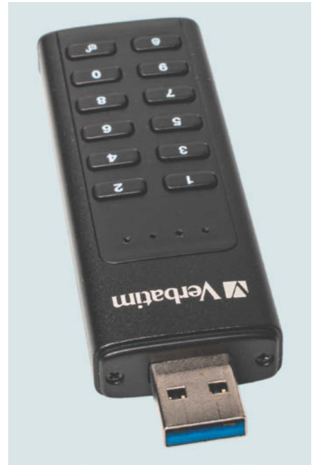
Bei USB-Sticks mit Hardware-Verschlüsselungsfunktionen muss man darauf vertrauen, dass der jeweilige Hersteller sie korrekt umgesetzt hat.
