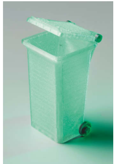
Die 3D-gedruckte halbtransparente Mülltonne erstrahlt mittels RGB-LED am Abend vor dem Abholtermin in der Farbe der jeweiligen Tonne und wirkt so als Erinnerungsmich.
