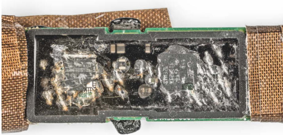
Beim Freilegen der Chips des DataLocker-Sticks habe ich diese beschädigt, sodass weitere Analysen nicht mehr möglich waren.
