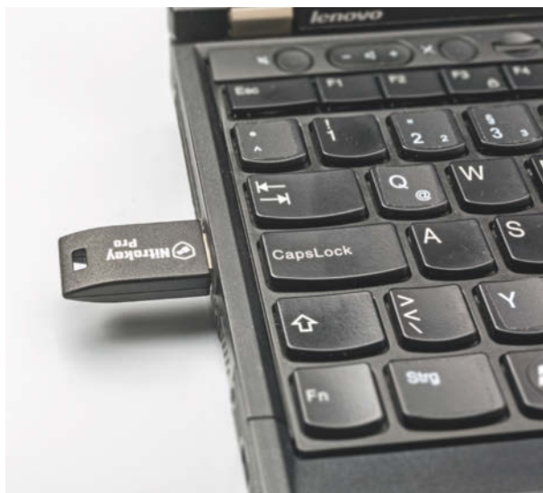
Die VeraCrypt-Verschlüsselung lässt sich an externe Sicherheitschips koppeln, etwa an den Nitrokey Pro.
