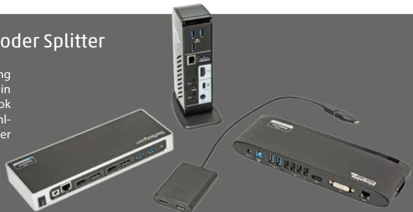
**Mit den DisplayLink-Adaptoren von Startech und zwei Mal Plugable (hintere Reihe) konnten wir je einen zusätzlichen Monitor an M1-MacBooks anschließen, ebenso wie mit dem USB-Splitter von i-tec (vorn).**
