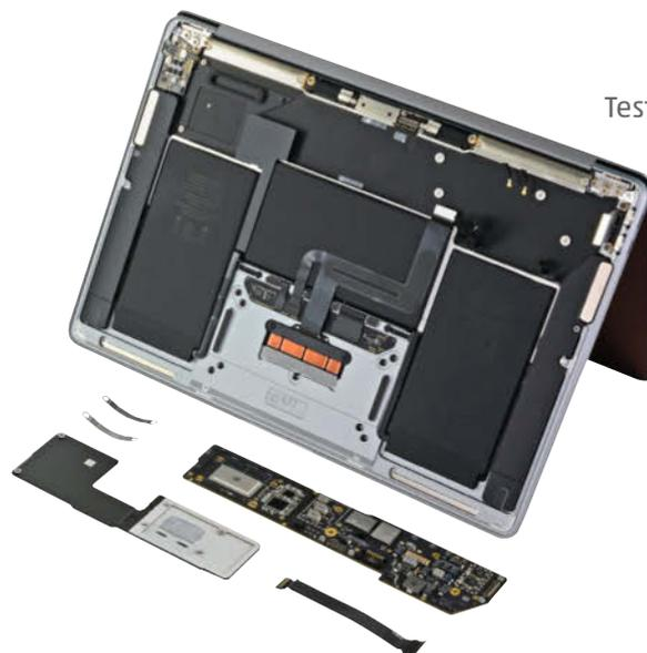
Der M1-Chip wird im MacBook Air (rechts) nur von einer Metallplatte gekühlt, beim MacBook Pro von einer Heat-Pipe, einem Kühlkörper und einem Lüfter.
