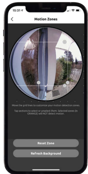
Ein großer Aufnahmewinkel führt zu starken Kissenverzerrungen. Die Erkennungszone kann eingegrenzt werden.
