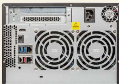
Platz für sechs Festplatten, 10 GBit, USB-A, USB-C und Thunderbolt bietet das TVS-672XT.
