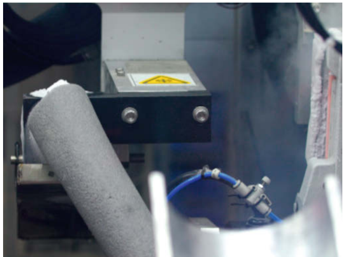
Kälteschock: Durch das blitzschnelle Vereisen des iPhones bricht der Kleber und der Akku lässt sich auslösen.
