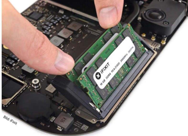
Beim bis vor kurzem noch angebotenen Mac mini mit Intel-CPU lässt sich das RAM durch Tausch der Steckmodule aufrüsten.
