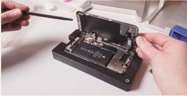
Das Display klappt man zur Seite weg, um die Kabel von der Hauptplatine abzuziehen.
