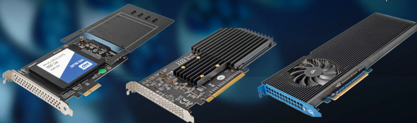
Sonnets Tempo Dual SSD PCIe Card hat Platz für eine oder zwei 2,5-Zoll-SSDs mit SATA 6G.
