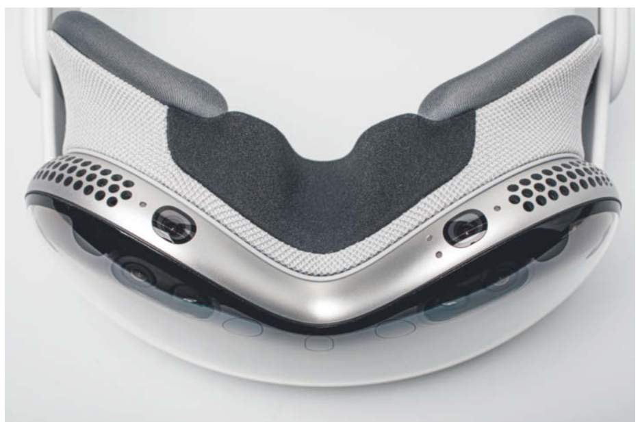
An der Unterseite der Vision Pro sitzen zwei Kameras für das Handtracking. Weitere Kameras zeigen nach vorne und zum Augentracking nach innen.
