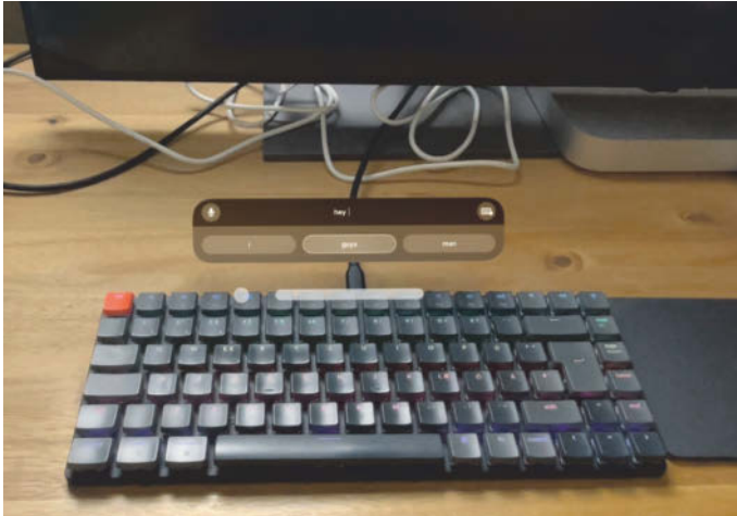
Über einer per Bluetooth oder wie im Foto per Mac-Fernsteuerung angebundener physischer Tastatur blendet visionOS ein virtuelles Fenster ein, das unter anderem die Vorschläge der Autokorrektur zeigt.
