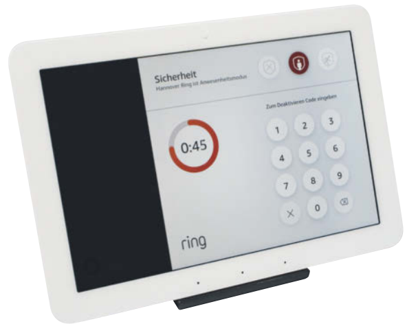
Über den Echo Hub lässt sich auch eine verbundene Ring-Alarmanlage ein- und ausschalten. Allerdings ist das Panel nicht gegen den Ausfall von Strom oder WLAN abgesichert.
