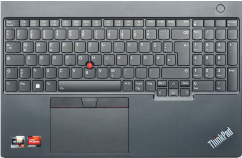
Bei vielen Notebooks braucht man etwas Training, um mit dem Tastatur-layout klarzukommen. Es gibt aber auch Streber: Das hier abgebildete Lenovo ThinkPad E16 Gen 1 [15] macht mit zweizeiliger Enter-Taste, großen Pfeiltasten dank nach vorne gerücktem Cursorblock, vierspaltigem Ziffernblock und Einschalter außerhalb des Tastenfelds alles richtig.
