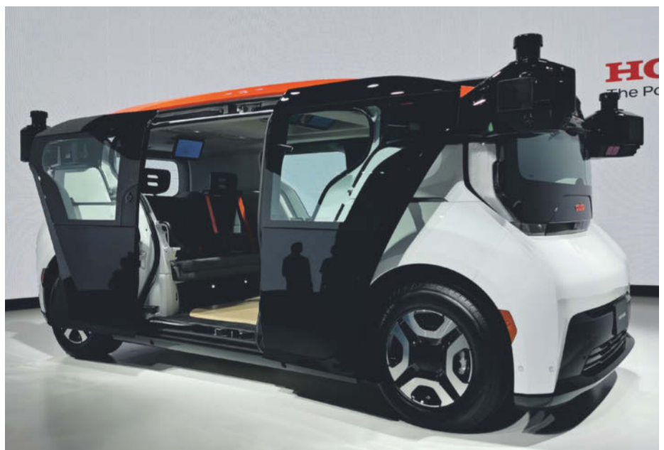
Hondas autonomer Kleinbus bringt es auf vier Sensortürme, die bis an den Rand mit Laser-, Infrarot-, Ultraschall- und Radarsensoren nebst klassischen Kameras vollgepackt sind.
