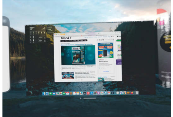
Die Vision Pro arbeitet als virtuelles Display an einem macOS-Rechner, dessen Tastatur und Trackpad man dann nutzt – dank „Universal Control“ steuert man damit auch die übrigen visionOS-Apps.
