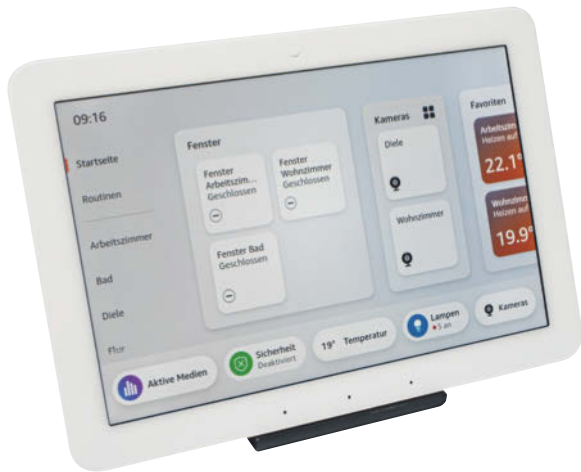
Das Dashboard des Echo Hub bietet mit einer Seitenleiste, Shortcuts am unteren Rand und Widgets mehrere Einstiege, um alle Smart-Home-Geräte im Haus abzufragen und zu steuern.
