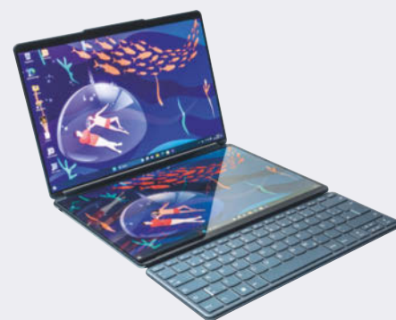
Das Yoga Book 9i hat zwei gleich große OLED-Touchscreens, doch den unteren kann man nur nutzen, wenn man die Bluetooth-Tastatur vor dem Gerät ablegt.
