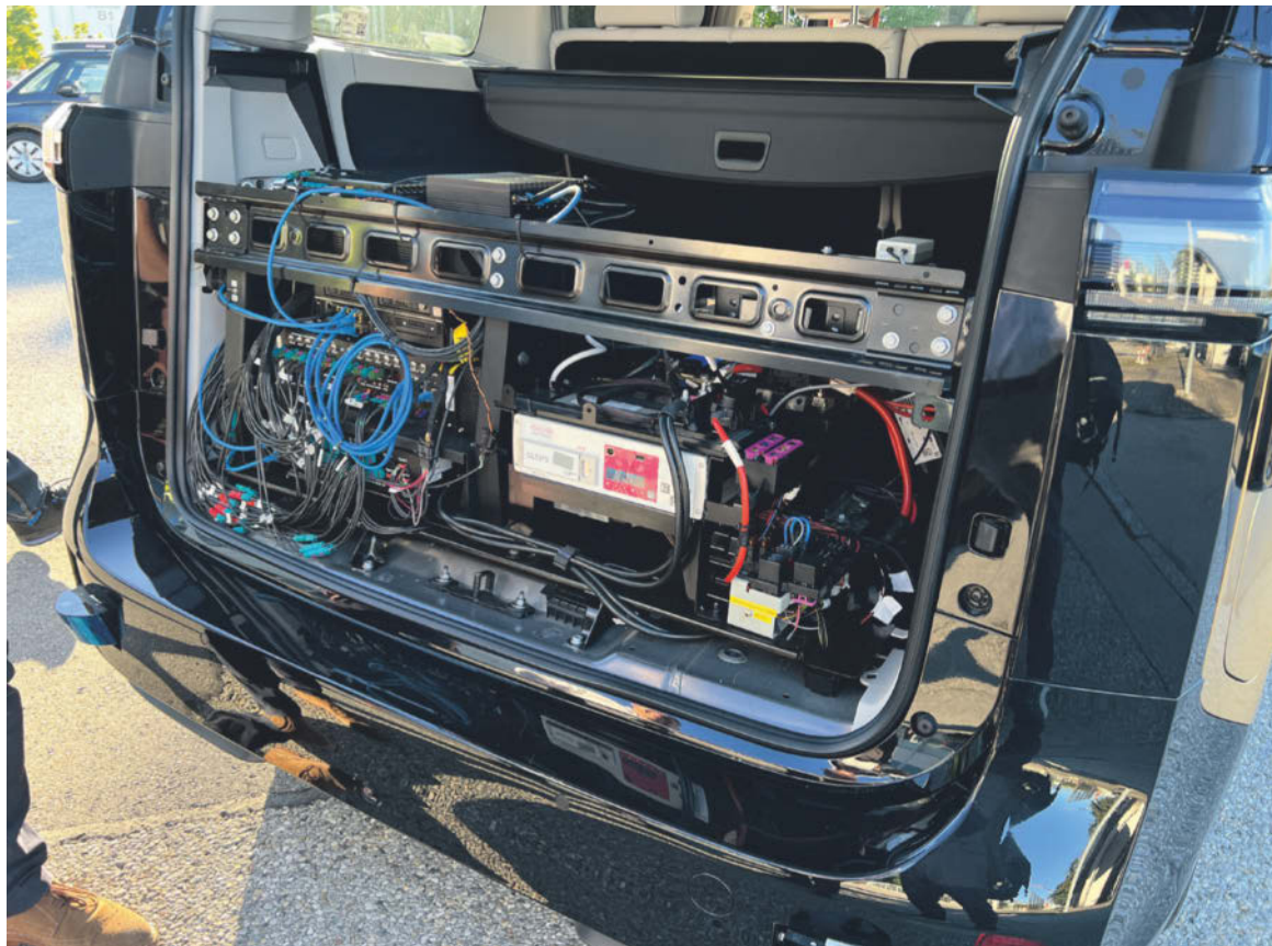
Welche Datenfluten die Moia-Busse verarbeiten, zeigt sich bei einem Blick auf die Recheneinheit im Kofferraum der Versuchsfahrzeuge.
