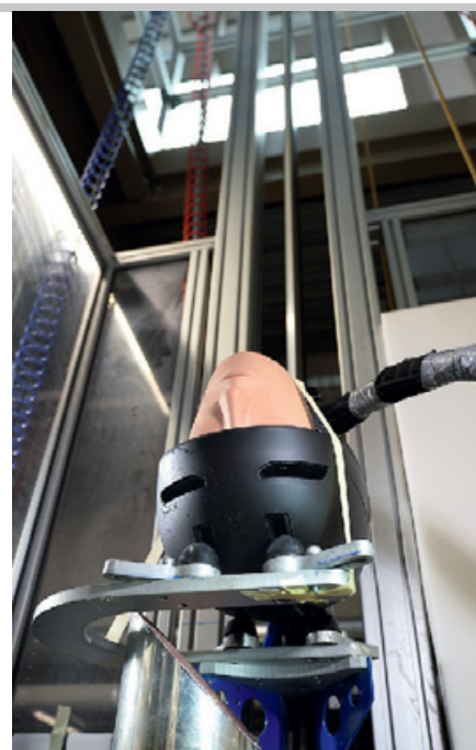
Sturz. Beschleunigungssensoren im Prüfkopf messen, wie stark der Helm den Aufprall dämpft.
