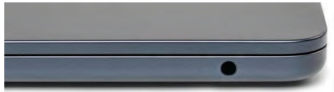
Auf der rechten Seite des MacBook Air kann man einen Kopfhörer anschließen, auch einen mit hoher Impedanz.
