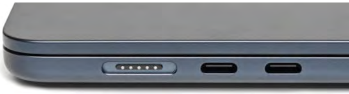
MagSafe 3 und zwei Thunderbolt-Ports mit USB4 finden sich auf der linken Seite des MacBook Air.
