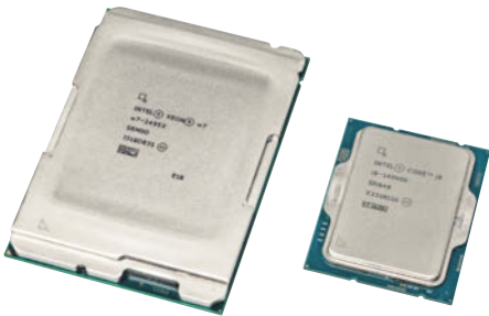
Nicht nur das Package, wie im Bild zu sehen, sondern auch der Chip des Xeon w7-2495X (links) ist im Vergleich zum Core i9-14900K größer.
