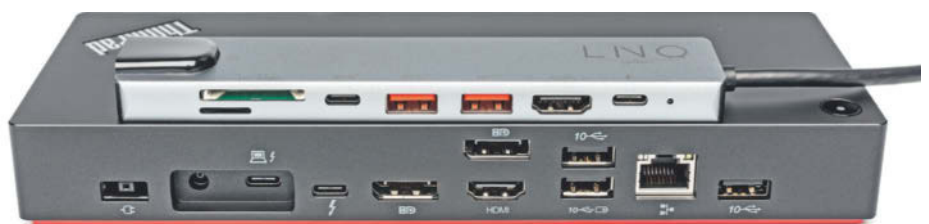
Das über 200 Euro teure Thunderbolt-4-Dock (unten) hat im Vergleich zum USB-C-Dock für 50 Euro (oben) zwar nur wenige zusätzliche Funktionen – aber die können den Mehrpreis lohnen. TB4 ermöglicht etwa den Anschluss schnellerer Speichermedien sowie von mehr Displays gleichzeitig.
