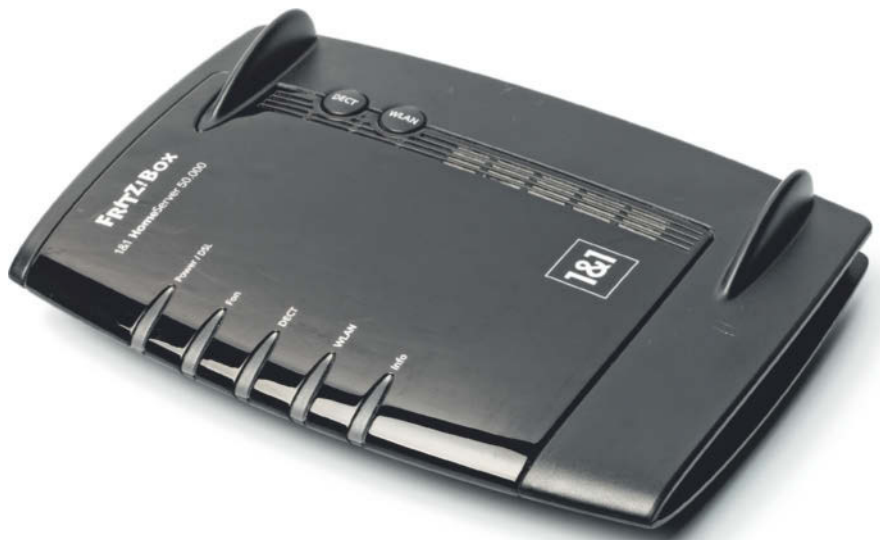
Die Fritzbox 7362 SL gibts für 5 bis 20 Euro im Netz. Ersetzt man FritzOS durch OpenWrt, kann man mehrere virtuelle Interfaces anlegen und so zwischen Heimnetzen hin und her routen.
