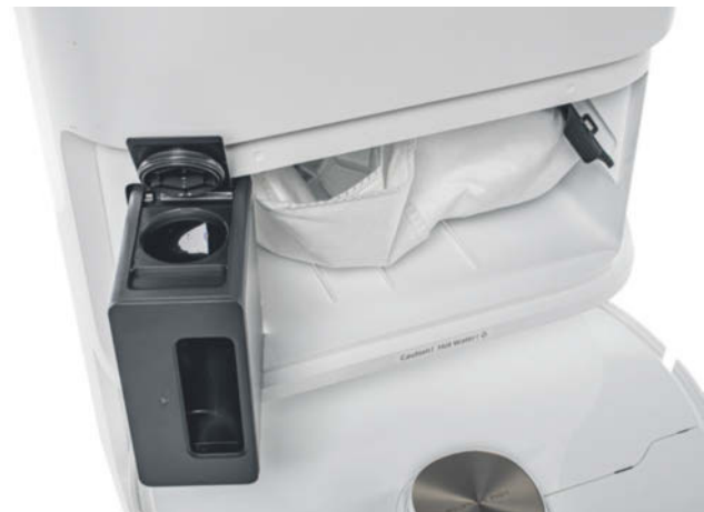
Unter den Tanks für Frisch- und Schmutzwasser steckt in der Basisstation ein herkömmlicher Staubsaugerbeutel, für den Schmutz, der aus dem Bot herausgesaugt wird.
