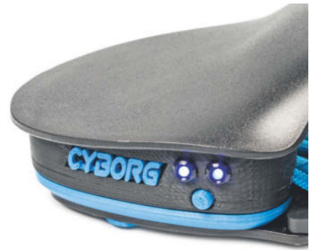
Der Azerox Cyborg speichert im Gerät zwei Tastenprofile, zum Wechseln gibt es einen kleinen Druckschalter. LEDs melden das aktive Profil.
