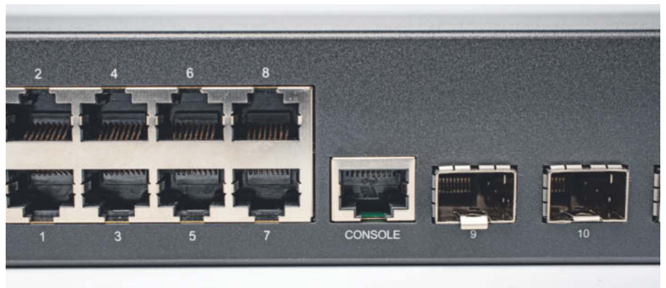
An die RJ45-Ports (links) der Switches hängt man PCs, Drucker, WLAN-Basen und andere Geräte. Die SFP+-Slots (rechts) nehmen Optikmodule oder DAC-Kabel auf. Der Console-Port gewährt dem Admin Zugang per serieller Schnittstelle, falls er sich beim Konfigurieren von VLANs vertan und aus dem Netz ausgesperrt hat.
