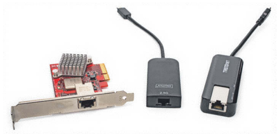
PCs und Notebooks bringt man das schnelle Netz mit einer Einbaukarte oder einem USB-Adapter bei. USB ist einfacher, schafft aber 5G-Ethernet derzeit nicht verlustfrei hinüber.
