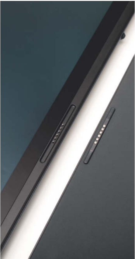
Liegt die Tastatur auf dem unteren Bildschirm auf, dann nimmt sie per Pogo-Pins statt Funk Kontakt zum Notebook auf und wird dabei auch geladen.
