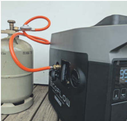
Mit der Propangasflasche entfällt das lästige Nachfüllen des mit vier Litern recht kleinen Benzintanks.
