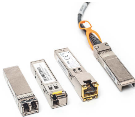
Optikmodule für SFP- und SFP+-Slots haben typischerweise zwei LC-Buchsen für den Hin- und Rückweg über zwei Glasfaseradern (links). Bidi-Module brauchen nur eine Ader, sie senden beide Richtungen über unterschiedliche Wellenlängen. Mit einem NBase-T-Modul kann man einen schnellen zusätzlichen Kupferport nachrüsten und DAC-Kabel (rechts) verknüpfen Geräte im selben 19-Zoll-Gestell.
