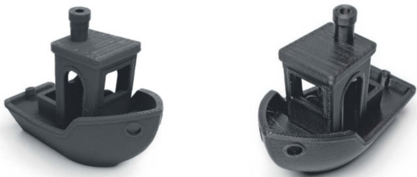
Die Druckqualität beider Drucker ist mit PLA fehlerfrei (links Bambu Lab, rechts Prusa). Selbst teure Profi-FDM-Drucker können den einsteigerfreundlichen Kunststoff nicht sauberer verarbeiten. Neigt das Material jedoch zu thermischen Spannungen, lösten sich bei beiden Maschinen im Test manche Drucke von der Platte.
