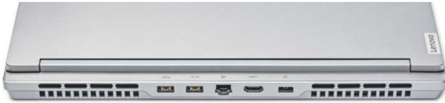
Lenovo platziert Netzteilanschluss, HDMI-Ausgang und LAN-Buchse hinten am Notebook, damit auf dem Schreibtisch keine Kabel stören.
