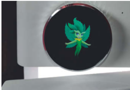
Bei offener Boxtür flattert die animierte Hey-abby-Hanffee auf dem Display des Entriegelungsdrehknopfs. In dem kleinen Loch rechts daneben verbirgt sich der Annäherungssensor.
