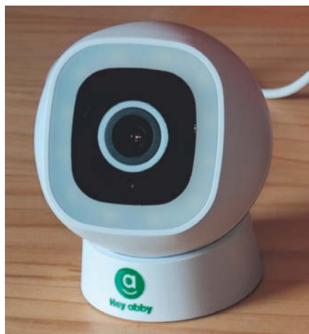
Die R1 Smart BudCam beobachtet die Pflanze in der Box; die Bilder im Querformat haben eine Auflösung von 2304 x 1296 Pixeln.
