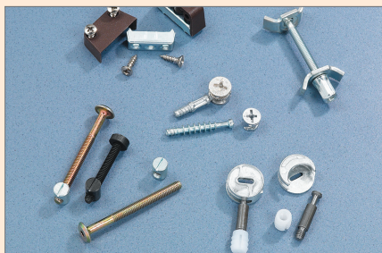
4 Lösbare Möbelverbinder: Trapez- und Arbeitsplattenverbinder (oben), unterschiedliche Exzenter und Schraubenverbinder, teilweise mit Einschraubdübeln (Mitte und unten). Die Materialien: verschiedene Metalle und Kunststoff oder ein Mix daraus.
