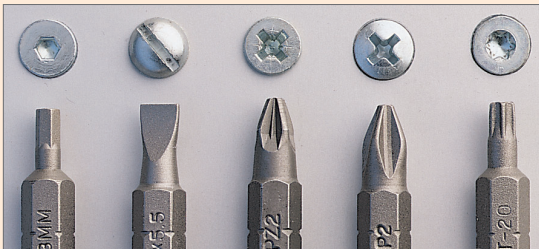
Die Antriebe (v. l.): Inbus, Flachschlitz, Pozidriv-Kreuzschlitz, Phillips-Kreuzschlitz und Torx.
