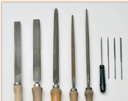
Eine Halbrund-, Flach- und Dreieckfeile sowie Rundfeilen. Die kleinen werden Schlüsselfeilen genannt (v. l.).
