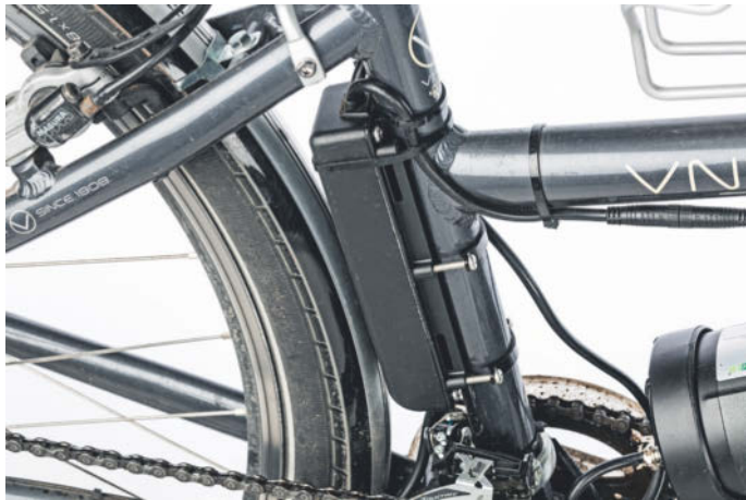
Der Motorcontroller findet nah am Hinterrad zwischen Schutzblech und Sattelrohr Platz.
