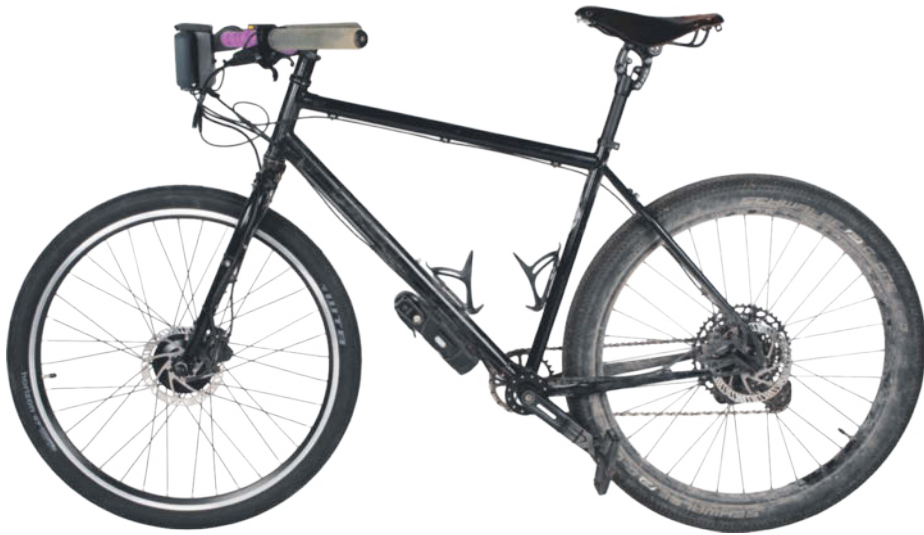
Das Swytch-Nachrüstsystem bringt gerade einmal 3,75 Kilogramm auf die Waage. Allerdings reicht der Akku nur für 15 bis 20 Kilometer.
