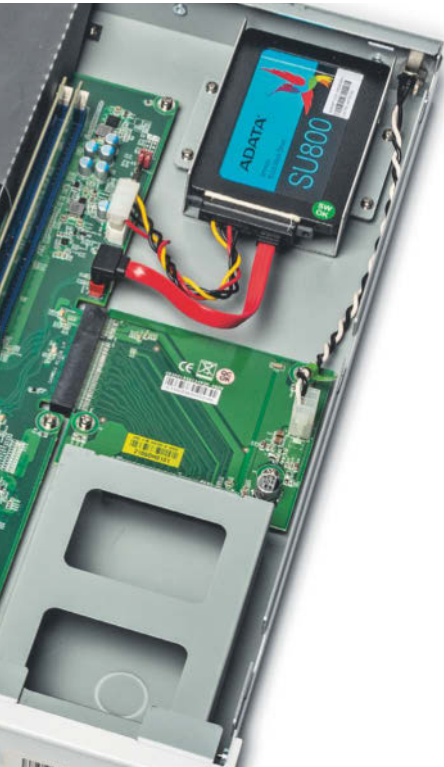
Beide SG-Modelle besitzen einen „FleXi“ genannten Erweiterungseinschub, der augenscheinlich nur ein x8-PCIe-3.0-Slot ist – allerdings mit der männlichen Seite auf dem Mainboard. Ob und wie er sich nutzen lässt, zeigen wir in einem der nächsten Hefte.
