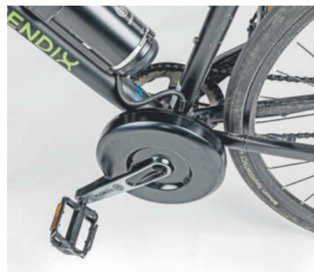
Der Pendix-Motor ersetzt die alte Kurbel des Umbaurads. Durch den tiefen Einbaupunkt ist verschmerzbar, dass die motorisierte Kurbel satte fünf Kilogramm auf die Waage bringt.
