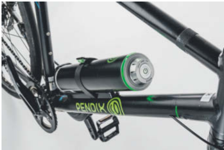
Die Unterstützungsstufe des Pendix stellt man per Drehrad am Akku ein.
