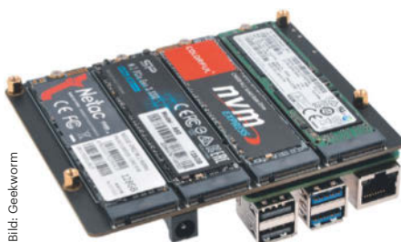
Das Geekworm SSD Shield X1011 sitzt unter dem Raspberry Pi 5; auf der Unterseite hat es vier M.2-Fassungen.
