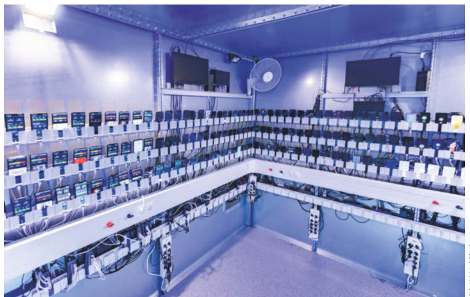
In einem abgeschirmten Raum simuliert 1&1 mit mehreren hundert Handys realen Betrieb in einem Testnetz.
