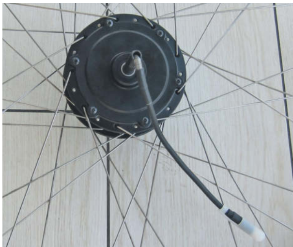
Einzigste Elektrifizierungs-Option bei diesem Tandem: ein Hinterradmotor.
