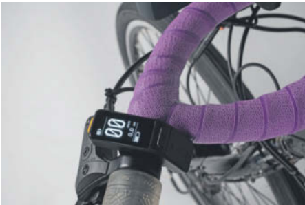
Das Lenkerdisplay des Swytch-Motors zeigt gefahrene Strecke, Geschwindigkeit und Unterstützungsstufe an.
