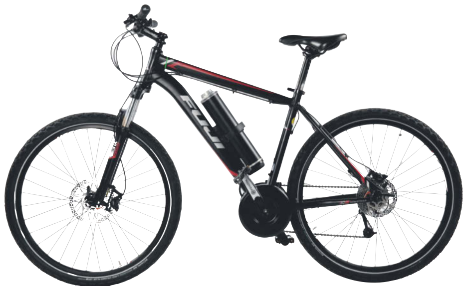
Der Pendix-Mittelmotor am Mountainbike: Im Gelände macht der Nachrüst-Mittelmotor eine bessere Figur als die beiden Nabenmotoren.
