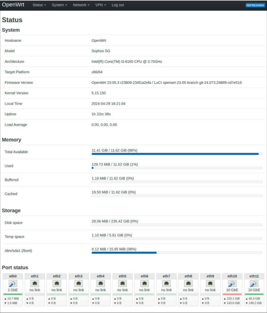
OpenWrt läuft problemlos auf den drei Firewalls. Da die Geräte mit x86-CPU's daherkommen, ist das System nur eine von vielen Optionen.
