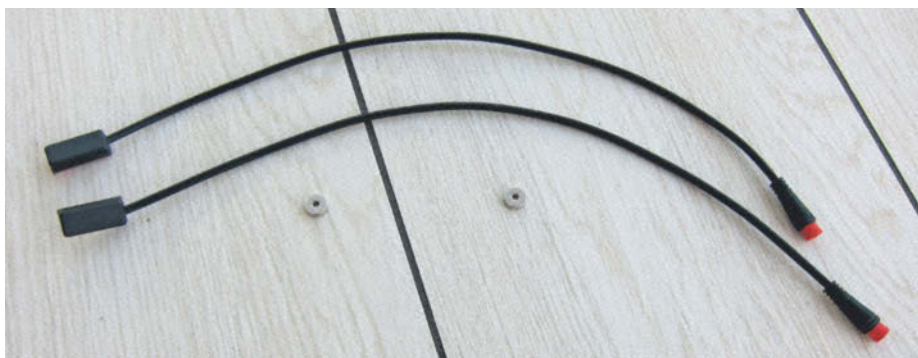
Die Basis für die Bastellösung: Bremssensoren mit Reed-Relais und Magnetringen.
