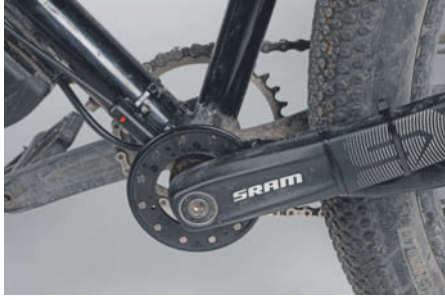
Die beiden Komponenten des Trittsensors des Swytch-Motors sind etwas wackelig angebracht, so erspart man sich aber den Ausbau der Kurbelgarnitur.
