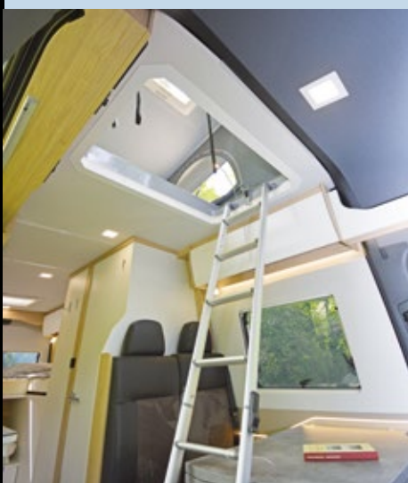
Der Aufstieg in den ersten Stock erfolgt über eine große Dachluke und einer Ein- hängeleiter, die tagsüber immer ein wenig im Weg ist.
