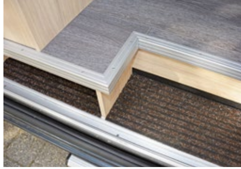
Scharfkantig: Die spitz zulaufende Metall-Profilleiste der integrierten Eingangsstufe steht weit heraus. Hier sollte der Hersteller nachbessern.
