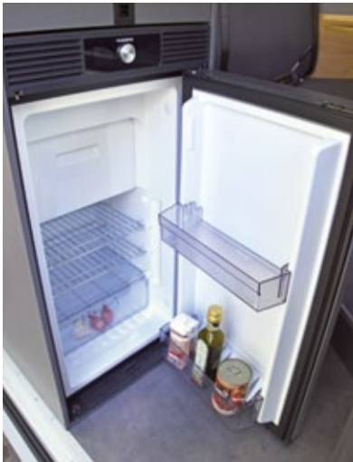
Die Arbeitsplatte der Küche lässt sich durch einen Auszug um 26 cm erweitern. Darunter befindet sich der Kompressor-Kühlschrank (70 Liter), dessen Tür sich nach zwei Seiten hin öffnen lässt.
