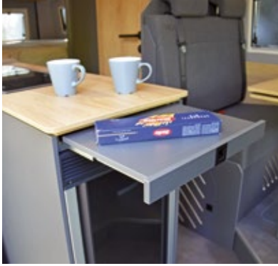
Die Arbeitsplatte der Küche lässt sich durch einen Auszug um 26 cm erweitern. Darunter befindet sich der Kompressor-Kühlschrank (70 Liter), dessen Tür sich nach zwei Seiten hin öffnen lässt.
