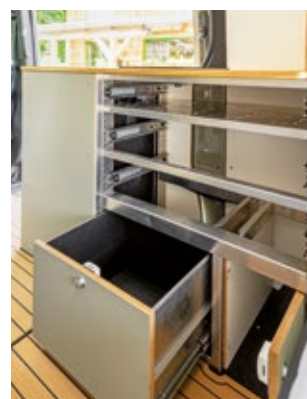
Erst auf den zweiten Blick ist das Grundgerüst aus Aluminium zu erkennen, das viele Kilos sparen soll.
