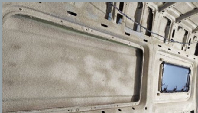
Mit Druckluft wird das Gemisch aus Kork und Öko-Bindemittel ohne allzu großen Aufwand aufgebracht. Selbst enge Stellen werden zuverlässig erreicht.
