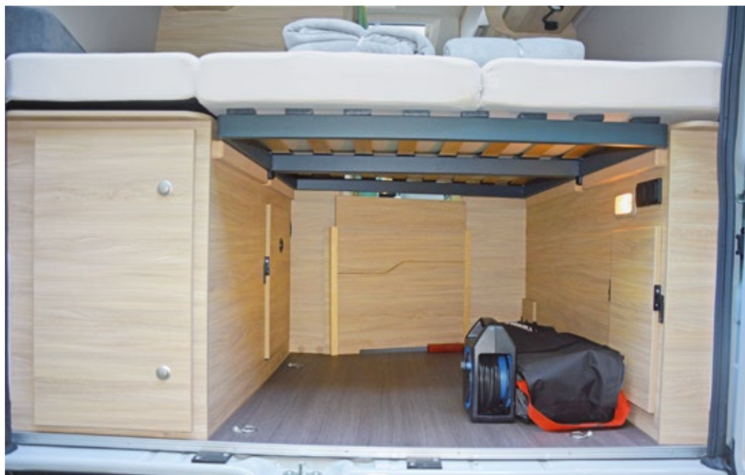
Der Heckstauraum ist 102 Zentimeter breit und 67 Zentimeter hoch. Die Lattenroste lassen sich herausnehmen, so reicht der Stauraum bis unters Dach.
