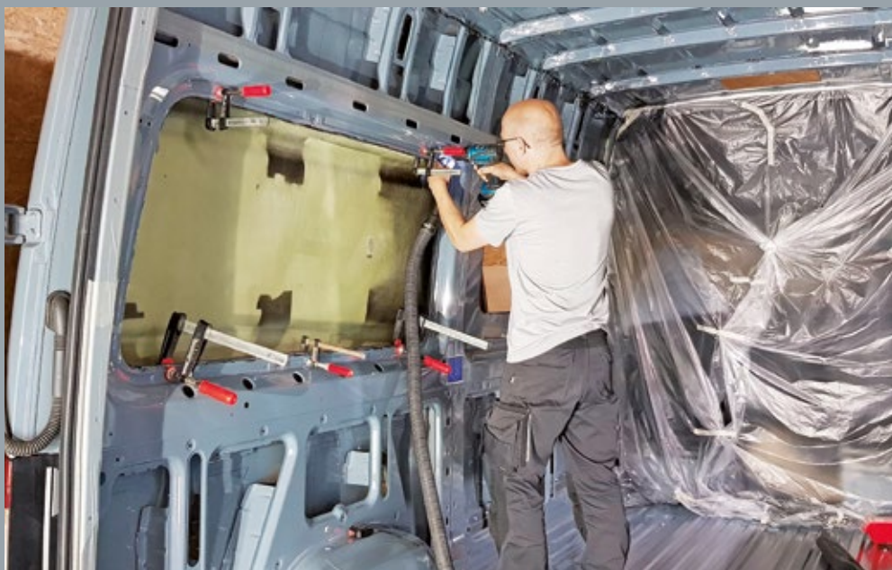
Karosserieverbreiterungen schaffen die nötige Liegelänge. Die Gfk-Teile wurden nach Vorgabe angebracht, also verklebt und verschraubt.
