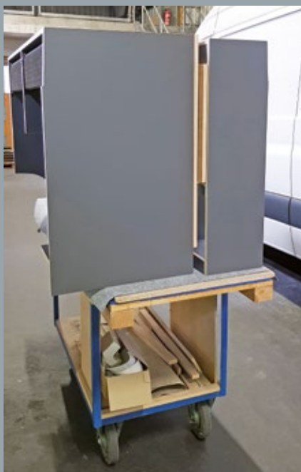
In der Möbelfertigung werden bereits die ersten Queenply-Leichtbauplatten verbunden. Das Farbkonzept steht ebenfalls: Korpusse in Anthrazit und Bambus plus Akzente in CamperVans-Orange.
