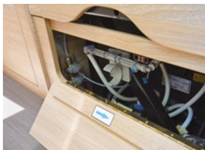
Im Detail: Gasabsperrhahn und Frostschutz-Ventil unter der Sitzbank (oben). Ablasshahn für Frischwasser hinter Klappe im Heckstauraum.
