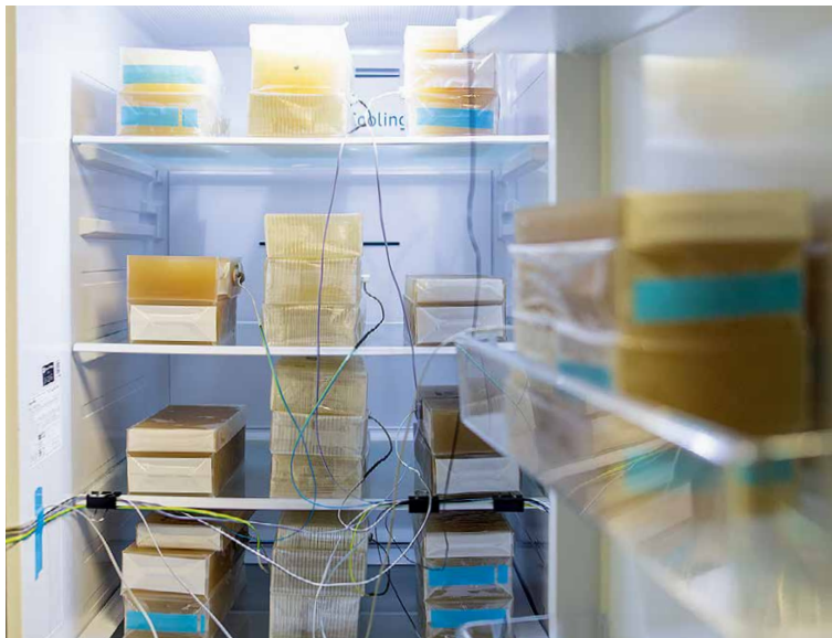
Wabbelkontakt. Aus vielen Prüfpaketen im Kühlschrank senden Temperaturfühler Kälteinfos live per Kabel.
