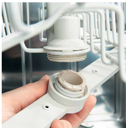
Sprüharm. Bei vielen Modellen lässt er sich ausklinken und durchspülen.
