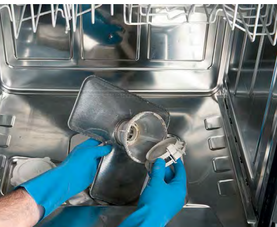
Siebe. Sie sind in den Maschinenboden geschraubt und abwaschbar.
