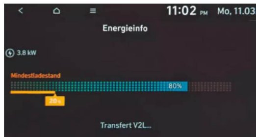
Der Ioniq zeigt die aktuell entnommene Leistung im Display an. Die Fahrbatterie wird maximal bis 20 Prozent entladen.
