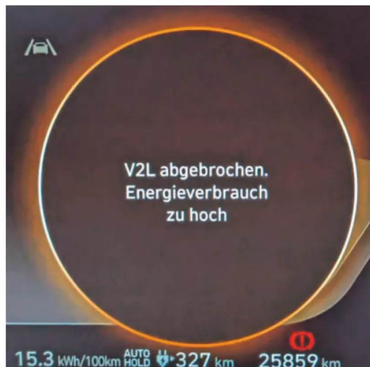
Ruft man zu viel Leistung ab, setzt der Ioniq die V2L-Versorgung aus.
