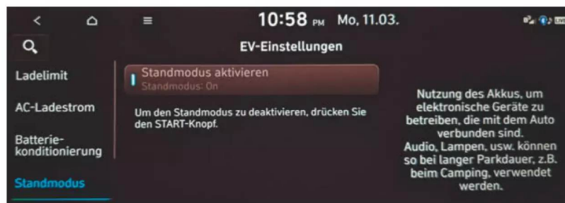
Im Menü des Ioniq 5 lässt sich der „Standmodus“ unter EV-Einstellungen aktivieren.
