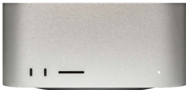
Was an den USB-C-Ports auf der Vorderseite anliegt, hängt von der CPU ab. Beim M3 Ultra gibt es zweimal Thunderbolt 5, beim M4 Max nur USB-C mit 10 GBit/s.
