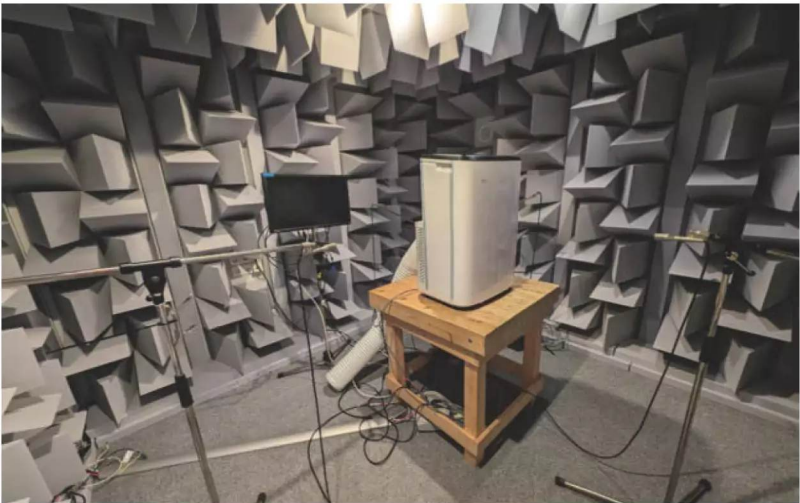
In der Messkammer zeigten sich zwischen den Modellen deutliche Unterschiede beim Geräuschpegel.
