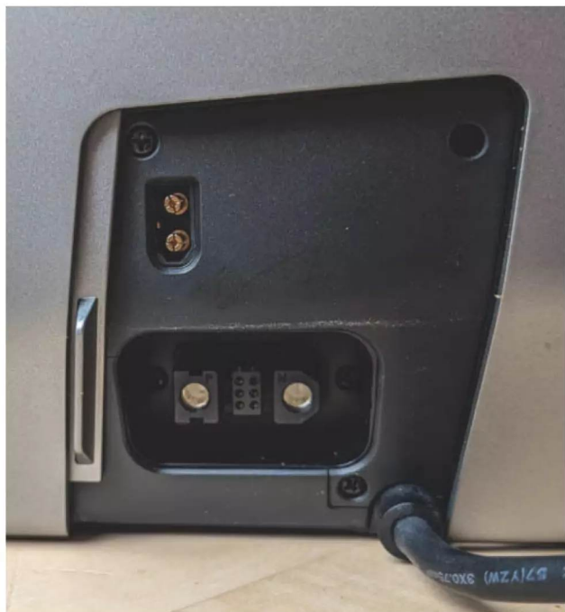
Der seitliche Power-Port bietet zwei DC-Anschlüsse für ein Solarmodul (XT60) und einen Ecoflow-Akku. Bei geschlossenem Port ist nur das Netzkabel zu sehen.
