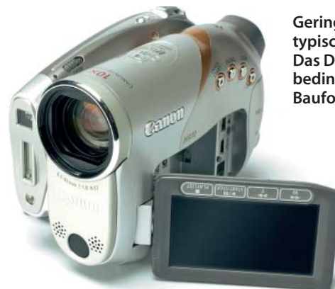
Spitzen-Auflösung, gute Kontraste: Mit dem Drehrad neben dem Display steuert man durch die Menüs des Canon HG10.
