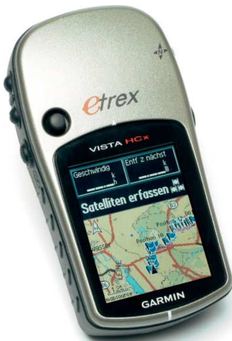
Der eTrex Vista HCx zeigt Vektorkarten auf einem Farbdisplay und berechnet auch Routen auf der Straße.
