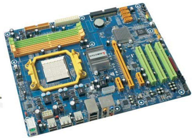
Das Biostar TA770 A2+ hat zwei eSATA-Ports, kann aber nicht mit DDR2-1066-Speicher umgehen.
