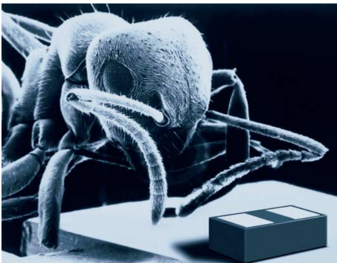
Die winzige Schutzdiode von Infineon kann elektrostatische Entladungen von bis zu 20 kV ableiten.
