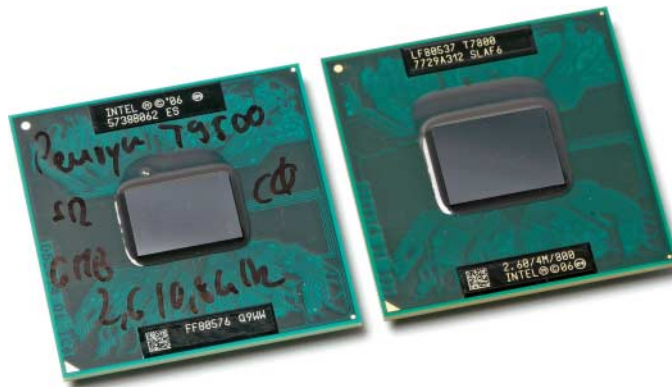
Das Penryn-Die (links) hat bei 25 Prozent weniger Fläche 41 Prozent mehr Transistoren als das Merom-Die.
