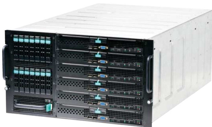
Bis zu sechs Dual-Xeon-Server im Blade-Format sowie 14 SAS-Disks passen ins Chassis des Modular Server System.
