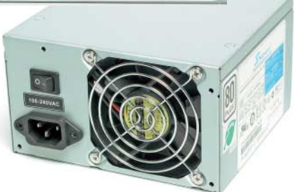
Seasonic SS-300ES: überstand auch den 2-kV-Stresstest und konnte so die schlechte Stützzeit kompensieren, laut bei Volllast
