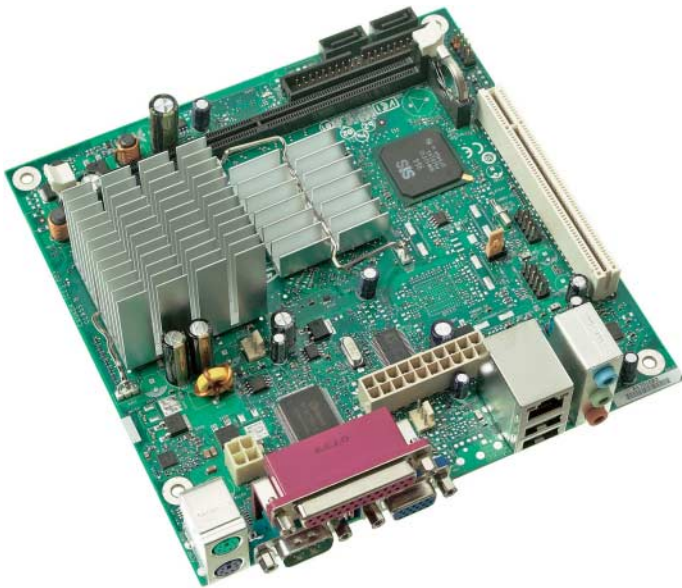
Für rund 60 Euro bekommt man das D201GLY2 mit Intels Spezial-Celeron 220; er ist zwar flotter als ein VIA C7, braucht aber auch deutlich mehr Leistung.
