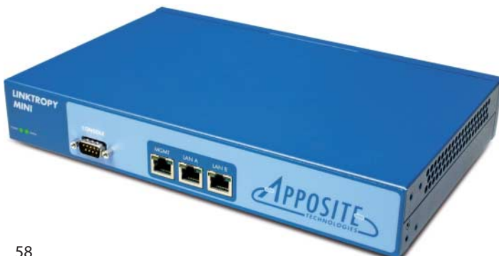
Das Linktropy Mini emuliert Bandbreite, Latenz sowie Fehler von WAN-Verbindungen und stellt die Verkehrstatistik grafisch dar.
