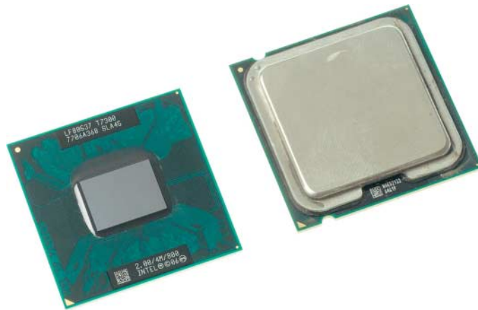
Mobilprozessoren (links) sind zwar sparsamer als solche für Desktop-Rechner, verlangen aber Spezial-Mainboards und -Kühler.
