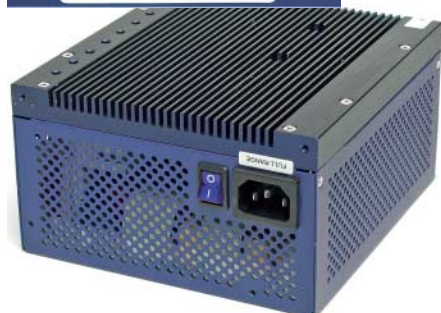
FSP Group ZEN400: höchste Effizienz im Test, bei jeder Last geräuschlos dank passiver Kühlung, bei Volllast sehr warm
