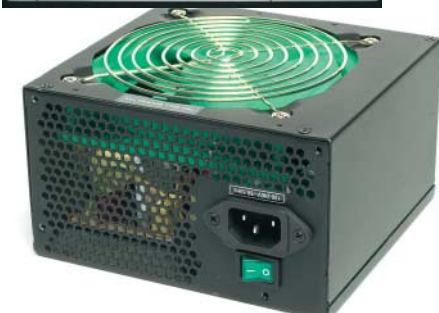
Jou Yje SGP-350AUBA: im Test Patzer beim Wirkungsgrad und der Störimmunität, zudem schon bei mittlerer Last recht laut
