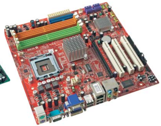
MSI G31M2-FD V2: kein HDCP, günstig, karges und schlecht voreingestelltes BIOS-Setup, Chipsatz unterstützt FSB1333 offiziell nicht
