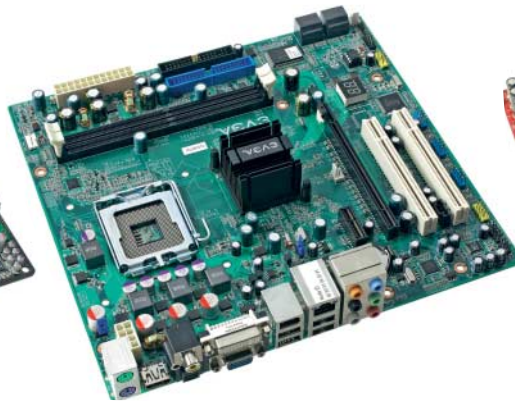
Evga e-7150/630i: Probleme mit der Lüftersteuerung und HDCP bei hohen Auflösungen; Dokumentation und Online-Support dürftig
