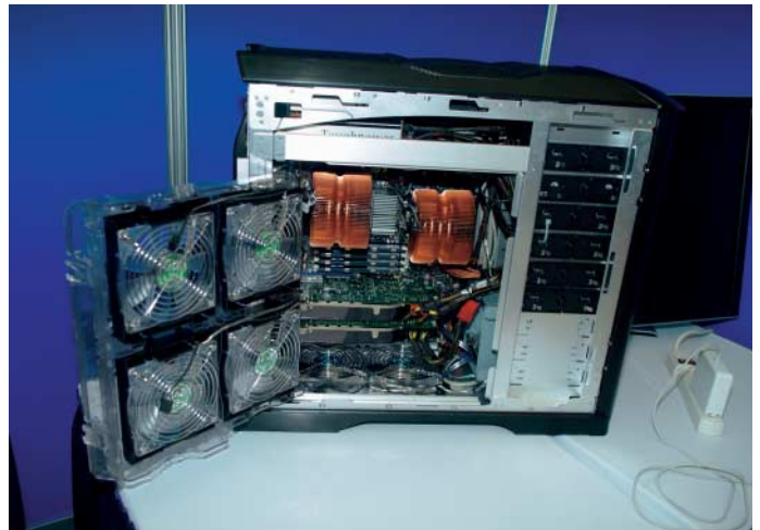
So gehts auch noch: Pat Gelsinger von Intel demonstriert mit „Skulltrail“ ein Highend-Gaming-System mit zwei CPUs und insgesamt acht Prozessorkernen sowie vier Grafikprozessoren, für das der Chipkonzern ein Netzteil mit mindestens 1200 Watt empfiehlt.
