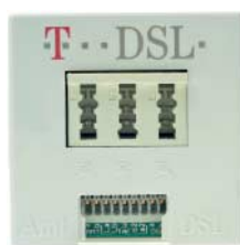
Derzeit liefert die Telekom ein weitaus kleineres Modell aus; auf der Platine ist InT1Com Systems aufgeätzt (Splitter 2).
