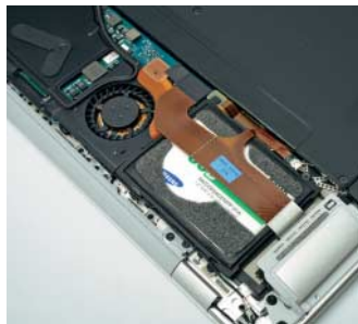
Die Flashspeicher-Festplatte (vorne) hat eine 1,8-Zoll-Bauform und ist nur 5 mm dick.
