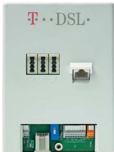
ADSL-Splitter sind auf den ersten Blick kaum zu identifizieren. Dieses Exemplar setzt die Telekom mit einem Siemens DSLAM ein (Splitter 1).
