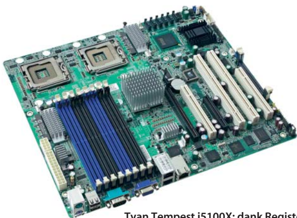
Tyan Tempest i5100X: dank Registered DIMMs deutlich sparsamer als das i5400PW, aber auch weniger Ausstattungsmöglichkeiten
