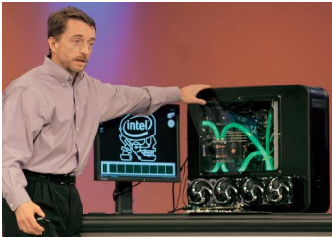
So gehts auch noch: Pat Gelsinger von Intel demonstriert mit „Skulltrail“ ein Highend-Gaming-System mit zwei CPUs und insgesamt acht Prozessorkernen sowie vier Grafikprozessoren, für das der Chipkonzern ein Netzteil mit mindestens 1200 Watt empfiehlt.
