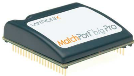
Der MatchPort b/g Pro bringt auch ältere Geräte dank SSH- oder SSL-Verschlüsselung sicher ins WLAN.
