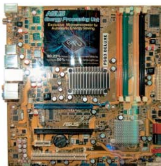
Asus P5Q3 Deluxe: zwei PEG-Slots auf einer Micro-ATX-Platine mit P45-Chipsatz
