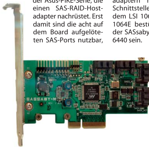
Den PCIe-SAS-Hostadapter SASsaby M bestückt Asus mit dem Marvell-Chip 6440.
