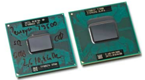
Der Penryn-Prozessor (links) hat bei gleicher Gehäusegröße ein 25 Prozent kleineres Die als der Merom.
