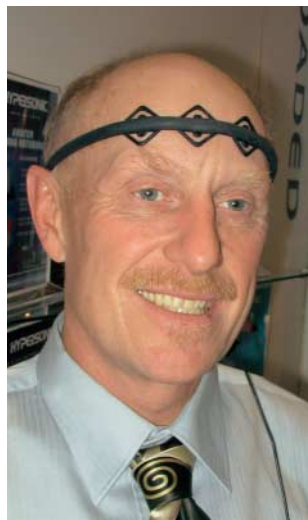
Drei Sensoren des Neural Impulse Actuator registrieren Augen- und Muskel-Bewegungen sowie elektrische Gehirnimpulse im Alpha- und Beta-Frequenzband, denen die Software Befehle zuordnet.
