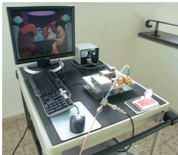
Bei einer Betriebsfrequenz von 300 GHz schickte das links gezeigte Sendegerät ein analoges Videosignal zum 22 Meter entfernten Empfänger (rechts).
