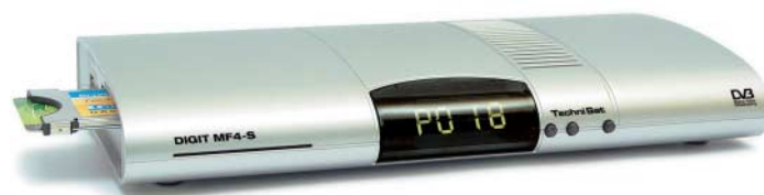
DVB-Receiver mit Common Interface lassen sich mittels Conditional Access Module und Smartcard (links) zum Empfang von Premiere überreden.
