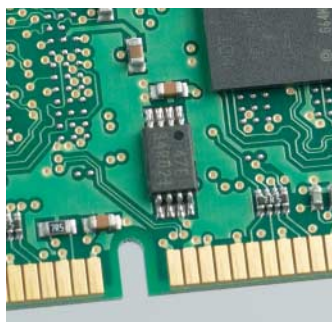
Das winzige SPD-EEPROM speichert eine Art „elektronisches Datenblatt“ des DIMMs.
