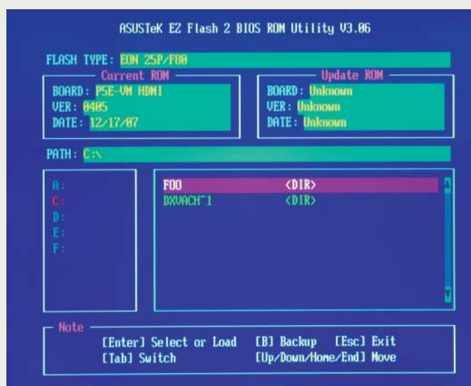
Moderne Boards wie dieses von Asus bieten über das BIOS aufrufbare Flash-Utilities zum Aktualisieren des BIOS von Diskette, Festplatte oder USB-Stick.
