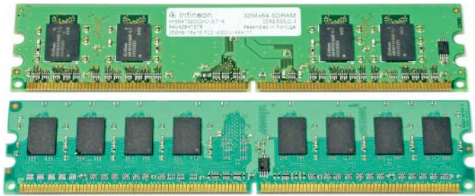
Beide Module speichern 256 MByte, doch das obere kommt mit vier 512-MBit-Chips aus, während das untere acht 256-MBit-SDRAMs trägt.
