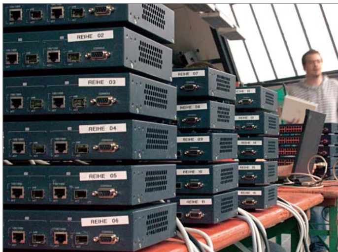
Gigabit-Switche verbinden die Rechner der Party-Gäste in der Halle – zusätzlich steht ein WLAN für sie bereit.
