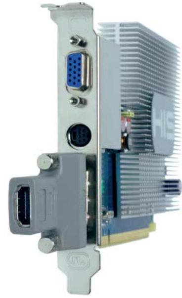
AMD/ATI-Grafikkarten können den Ton direkt per HDMI über einen Adapter ausgeben, allerdings ist man auch hier auf SPDIF-kompatible Tonformate beschränkt.
