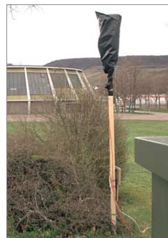
Diese wetterfeste WLAN-Basisstation empfängt die Videodaten aus dem Seminarraum von der anderen Straßenseite.
