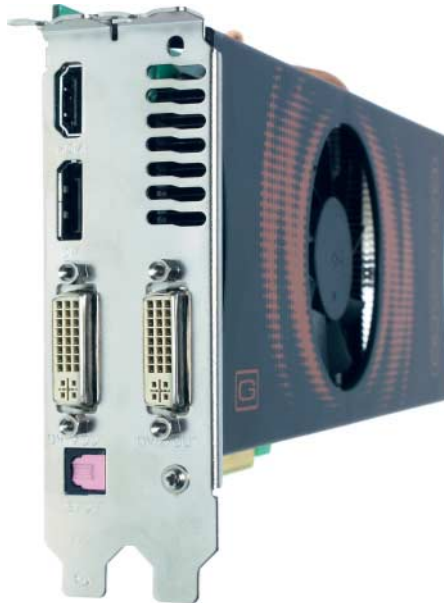
Nvidia-Grafikkarten bringen zuweilen einen HDMI-Anschluss mit, dessen Ton allerdings per SPDIF von der Soundkarte eingespeist werden muss.
