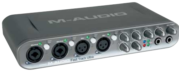
Links: Fast schon eine kleines Mischpult: das Fast-Track-Ultra von M-Audio
