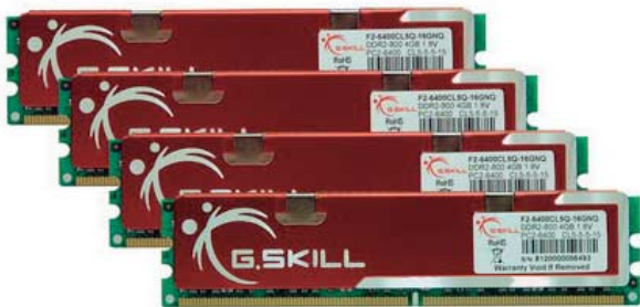
Speichermodule mit je 4 GByte Kapazität sollen Desktop-Rechnern bis zu 16 GByte Hauptspeicher beschern.
