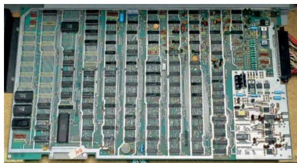
Mehr als die Hälfte dieses TTL-Grabs realisiert den Vektorgenerator, einen Spezialprozessor zur Ansteuerung des Bildschirms.
