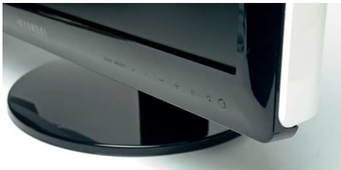
Die Sensortasten des W240D lassen sich nur unter direkter Beleuchtung erkennen.
