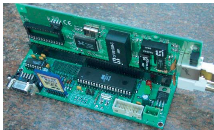
Der 8-bittige Atmel-Controller kommuniziert mit der NE2000-Netzwerkkarte über das ISA-Interface. Um Speicherplatz zu sparen, ist nicht der vollständige TCP/IP-Stack implementiert.
