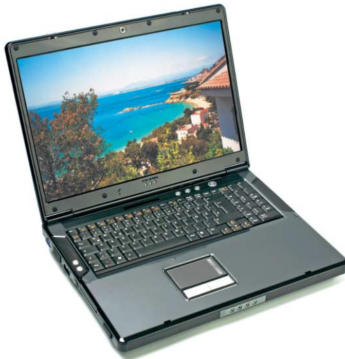
Clevo D901C, das hierzulande von verschiedenen kleinen Notebook-Händlern angeboten wird, setzt beim Prozessor auf Desktop-Versionen bis hin zu QuadCore-CPU's; in dem Gehäuse haben drei 2,5-Zoll-Platten Platz.
