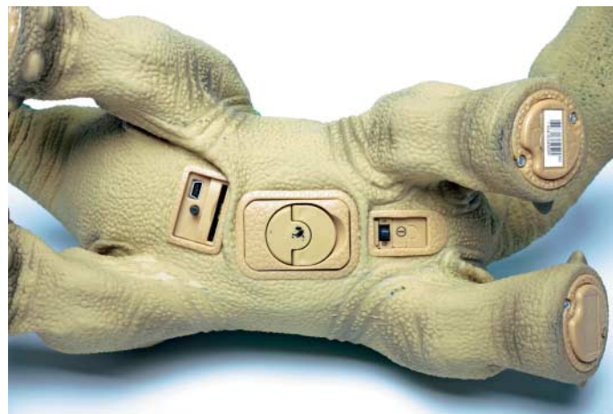
Über den SD-Karten-Slot versorgt man Pleo mit neuer Firmware, modifiziertem Verhalten oder bringt ihm andere Sounds bei.
