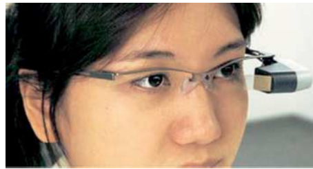
Brothers Miniaturprojektor nutzt die Augennetzhaut als Leinwand.
