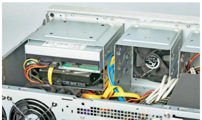
HTPC-Gehäuse bieten wenig Platz für die vibrations-entkoppelte Montage von 3,5-Zoll-Festplatten; ein Lüfter hinter der Frontplatte fächelt Frischluft herein.
