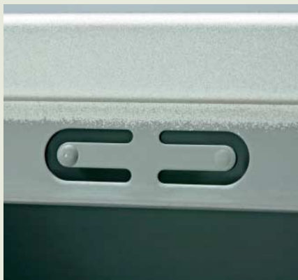
Metallfedern verbessern den Kontakt zwischen Seitenwand und dem Gehäuserahmen. Damit wird eine bessere elektromagnetische Abschirmung erreicht.
