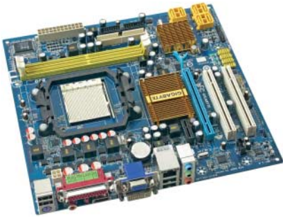
Gigabyte GA-MA74GM-S2H mit 740G: günstiges Board mit etwas leistungsschwacherem Chipsatz, SPDIF-Ausgang, startet langsam, ordentliche Lüfterregelung
