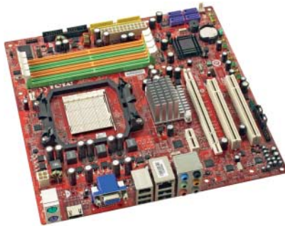
MSI K9A2GM-FIH mit 780G: lahm bei RAID-0 und FireWire-Transfers, Work-around für TLB-Bug nicht aktiviert, nur vier SATA-Ports
