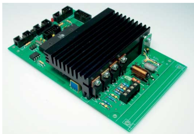
So haben wir uns die Kühlkörper-Montage (hier unser nicht ganz finaler Prototyp) gedacht: Es entsteht eine kompakte Einheit, die mit Lüfter gut 50 W umsetzen kann.
