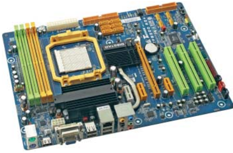
Biostar TF8200 A2+ mit GeForce 8200: startet schnell, aufwendige Kühl- konstruktion, Audio-Ausgabe per HDMI arbeitet nicht
