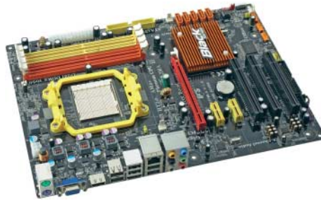
Elitegroup GF8200A mit GeForce 8200: eSATA-Anschluss für externe Festplatten, Online-Support dürftig, On-Board Ein/Aus- und Reset-Taster
