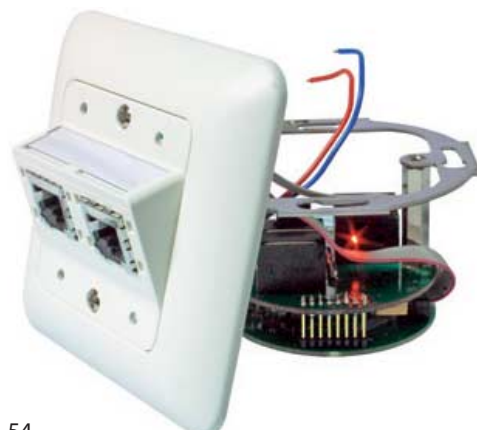
Der POF-Switch RP4-Link für Unterputzdosen koppelt zwei optische und zwei elektrische Fast-Ethernet-Ports.
