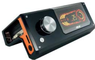
Die XG Station von Asus stellt mittels ExpressCard-Einschub Notebook zu einem beliebigen Notebook hin; in ihr arbeitet ein GeForce 8600 GT.
