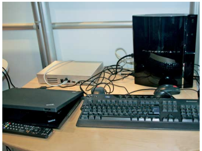
Die Playstation 3 renderte am IBM-Stand in Echtzeit fünf PAL-TV-Streams des Server-Prototyps (hinten links) und ein Hintergrundbild zu einem Full-HD-Fernsehbild.
