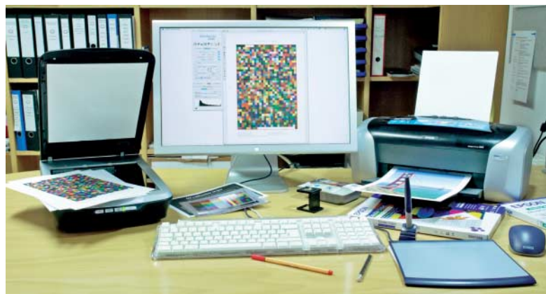
Bei der Druckerkalibrierung mit Silverfast Ai ersetzt ein kalibrierter Flachbettscanner teure Messtechnik.
