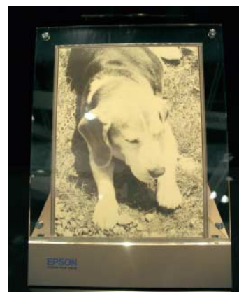
Epsons Graustufen-display aus elektronischer Tinte zeigt eine Auflösung von 385 ppi.
