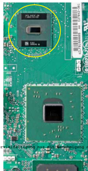
Skuril: Beim Intel-Board D945GCLF mit Atom 230 kühlt der Lüfter den Chipsatz – nicht die CPU.
