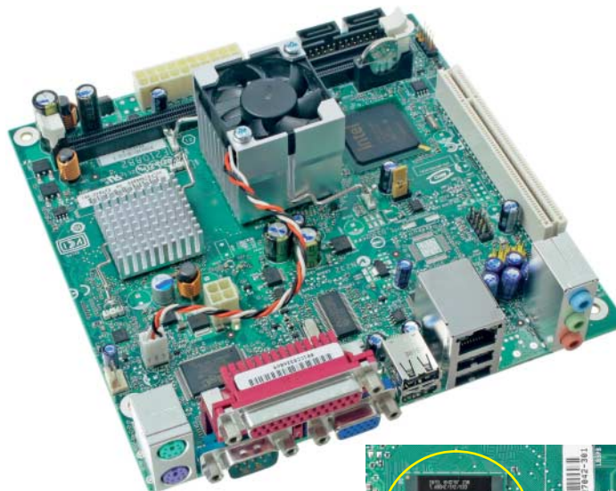
Skuril: Beim Intel-Board D945GCLF mit Atom 230 kühlt der Lüfter den Chipsatz – nicht die CPU.
