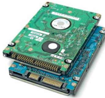
Am Stecker lassen sich SATA- (unten) und PATA-Platten (oben) einfach auseinanderhalten. Und ausbauen muss man die Platte eh.
