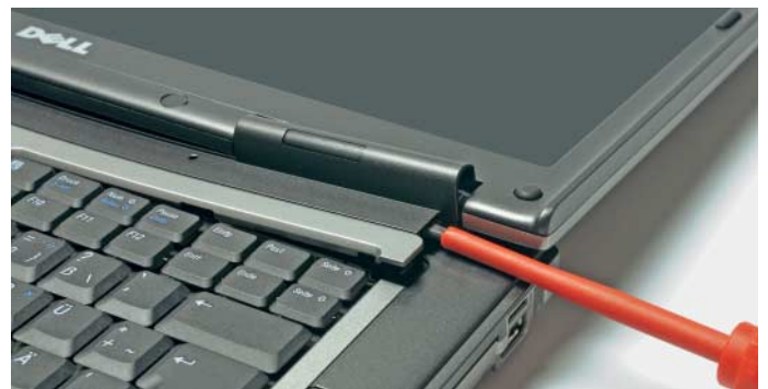
Sobald die Halterung etwas angehoben werden kann, hat der Schraubendreher seine Arbeit getan.
