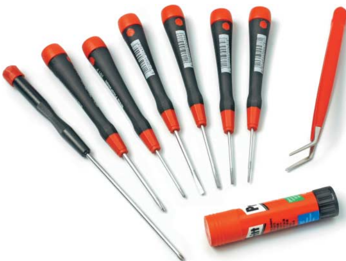
Die Werkzeug-Grundausstattung für schwierige Fälle: Feine Schraubendreher, Pinzette – und ein Klebestift. Etwas Kleber am Schraubendreher befördert auch tief sitzende Schrauben nach draußen und hinterlässt keine Rückstände.
