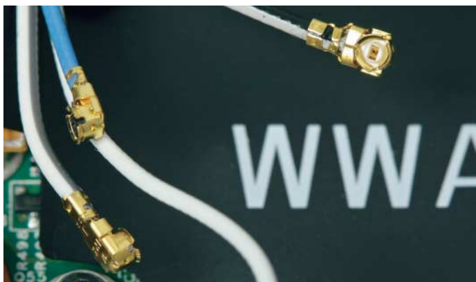
Die dünnen, empfindlichen Antennenstecker dürfen nicht verkantet werden und halten nur wenige Steckvorgänge aus.
