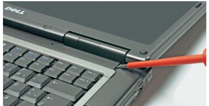
Das Dell Latitude D830 zeigt mit der Einbuchtung, wo der Schraubendreher ansetzen muss, um die Tastaturblende zu entfernen – aber bitte nur mit breiter Klinge, um das Plastik nicht zu beschädigen.
