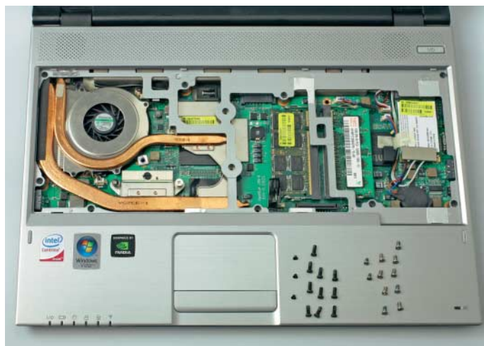
Wohl dem, der nur den Speicher aufrüsten will. Die Festplatte dagegen ist gut versteckt. 24 Schrauben an der Ober- und Unterseite müssen raus – rekordverdächtig.
