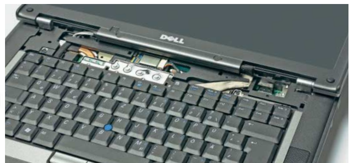
Danach liegt die Tastatur frei, und der zweite RAM-Slot kann bestückt werden. Der erste liegt gut zugänglich an der Unterseite, ist aber gemeinerweise von Dell immer belegt.
