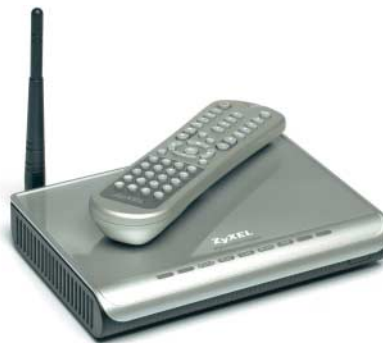
Den DMA 1000W von Zykel kann man nur mit unsicherem WEP-Schutz ins WLAN einbinden.
