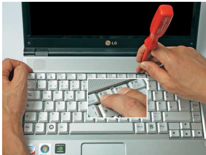
Um die Festplatte beim LG P300 zu tauschen, muss zunächst die Tastatur aus dem Gehäuse: zwei Schrauben unten und vier Federhäkchen oben.
