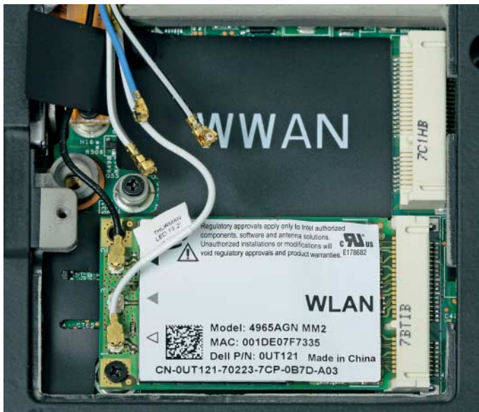
So sieht ein Upgrade-freundlicher MiniCard-Platz aus: Drei Extra-Antennen für Mobilfunk und Draft-N-WLAN liegen bereit.
