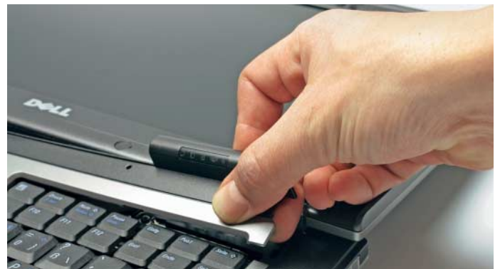
Mit der Hand dreht und wackelt man kräftig, aber mit Fingerspitzengefühl, bis sich die Abdeckung wie von selbst löst.
