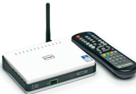
Der D-Link DSM-510 kann DRM-geschützte Kaufvideos abspielen, lässt sich aber nur mit unsicherem WEP-Schutz ins WLAN einbinden.
