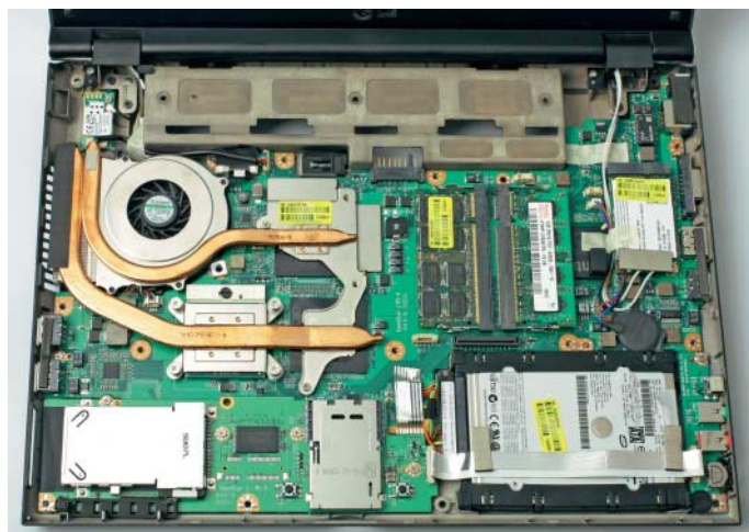
Nach Entfernen diverser Steckerchen und des empfindlichen Plastikrahmens liegt der Datenspeicher endlich frei zugänglich vor einem. Wieder einmal zeigt sich: je kompakter das Notebook, desto schwieriger das Aufrüsten.
