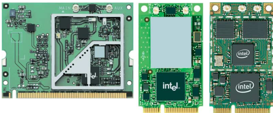
In älteren Notebooks ist das WLAN per Mini-PCI (rechts) angebunden. Neuere nutzen die kleinere PCI-Express-Version MiniCard, wobei die Module mit IEEE 802.11a/b/g (Mitte) zwei Antennenanschlüsse haben, die mit Draft-N drei (links).
