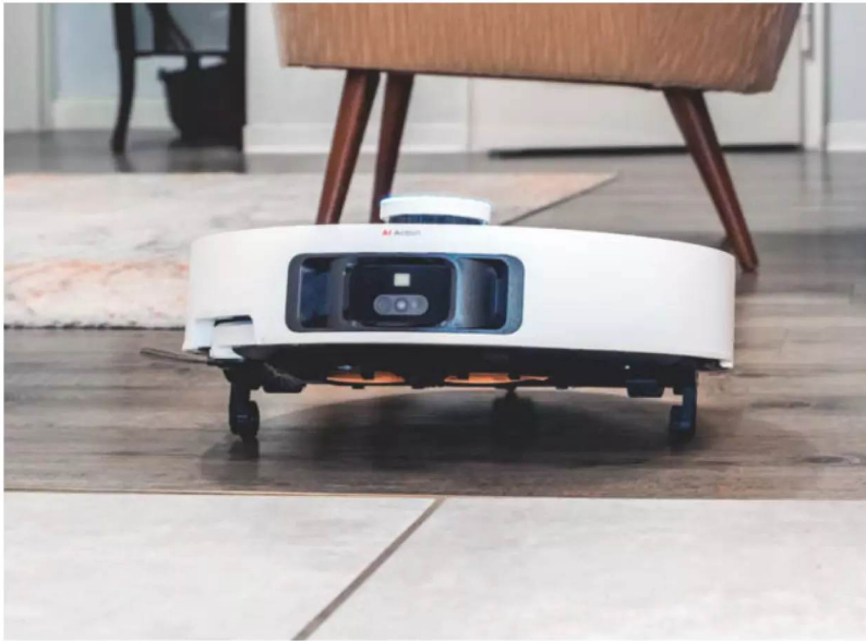
Beide Roboter des Tests strecken sich, um Schwellen zu überwinden. Der Dreame X50 kommt wegen seiner Gelenkbeine höher.
