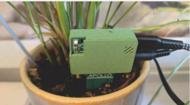
Der Apollo PLT-1 zeigt seine Platine oben links – das ist beim Gießen nicht optimal.
