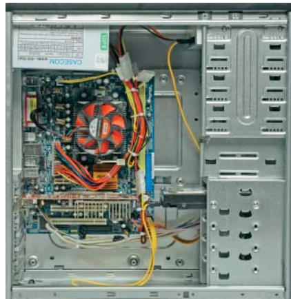
Bei der Montage haben die Mindfactory-Techniker geschludert und einige Frontanschlüsse des recht flotten PCs verwechselt.
