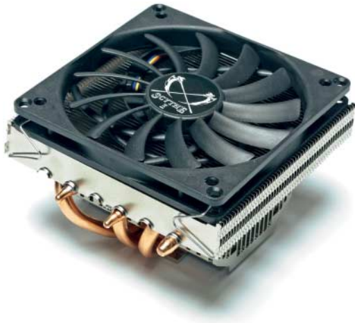
Scythe unterzieht beim Shuriken nicht nur den Kühler, sondern auch den Lüfter einer Schrumpfkur.
