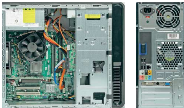
Dem Vostro 200 MT spendiert Dell nur einen lahmen Einkernprozessor, baut den Rechner dafür solide auf.
