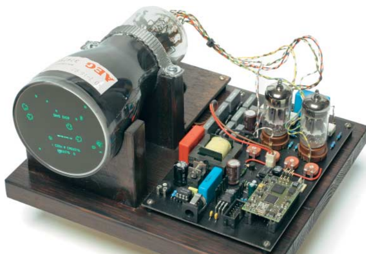
Beispiel für eine weitgehend zweckfreie, wenngleich höchst amüsante FPGA-Entwicklungsarbeit des Autors: Ein voll funktionstüchtiger „Asteroids“-Spielautomat nach den Originalplänen von 1979 im Spartan-3-FPGA. Das Steampunk-Design gewinnt durch die alte Oszilloskop-Röhre und eine Ablenskschaltung mit ECC83-Trioden. Für die Spielpausen ist noch eine Uhr eingebaut (rechts) – die auf einem eigenen „Mikroprozessor“ im FPGA läuft.
