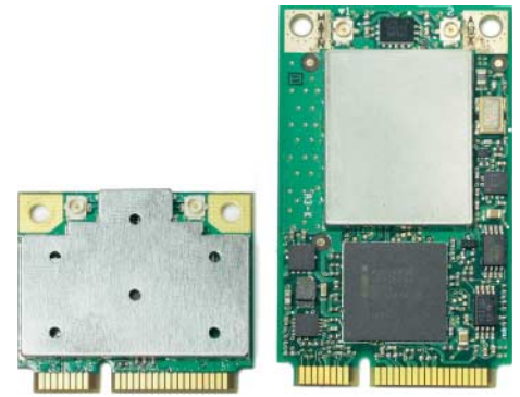
Die halbhohen MiniCards (links) haben den gleichen Anschluss wie die normalen, lassen sich aufgrund anders positionierter Befestigungen aber nicht in den größeren Slots verwenden.
