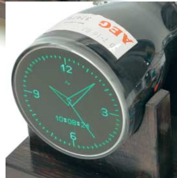
Beispiel für eine weitgehend zweckfreie, wenngleich höchst amüsante FPGA-Entwicklungsarbeit des Autors: Ein voll funktionstüchtiger „Asteroids“-Spielautomat nach den Originalplänen von 1979 im Spartan-3-FPGA. Das Steampunk-Design gewinnt durch die alte Oszilloskop-Röhre und eine Ablenskschaltung mit ECC83-Trioden. Für die Spielpausen ist noch eine Uhr eingebaut (rechts) – die auf einem eigenen „Mikroprozessor“ im FPGA läuft.
