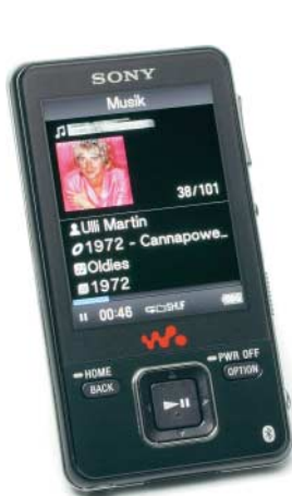
Sonys NWZ-A829 bietet ein Bluetooth-Profil zur Übertragung von Stereoton.
