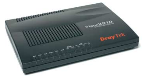
Der DrayTek Vigor2910 steuert ein oder auch zwei Breitbandmodems. Die Lastverteilung lässt sich flexibel regeln.
