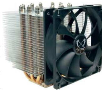
Sechs Heatpipes leiten die Prozessorwärme beim Scythe Ninja 2 zu den Lamellen ab.
