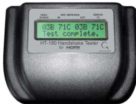
Der HT-180 analysiert HDMI-Signale und prüft, ob alle angeschlossenen Geräte standardkonform sind.
