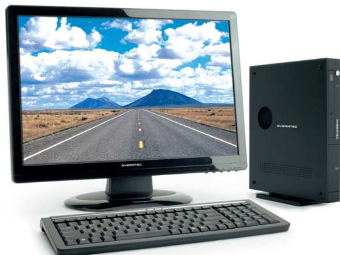
TriGem verwendet beim Averatec Black Crystal teilweise Mobilkomponenten und kommt daher mit einem kompakten Gehäuse aus.
