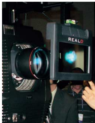
RealD-Technik polarisiert die Bilder abwechselnd – und benötigt nur einen Projektor.
