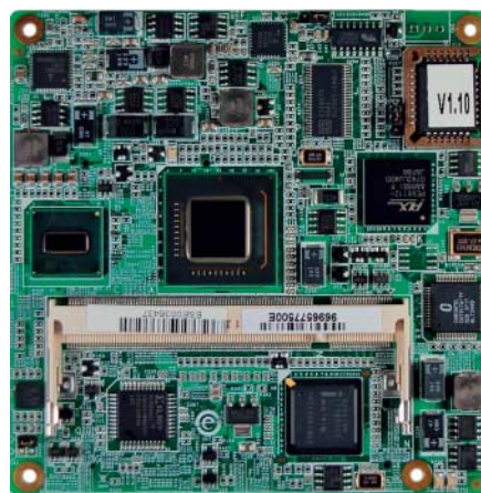
Die COM-Express-Micro-Platine SOM-5775 bringt alle wesentlichen Teile eines PC mit. Das Basis-Board muss nur noch die Schnittstellen nach außen führen und die Stromversorgung übernehmen.
