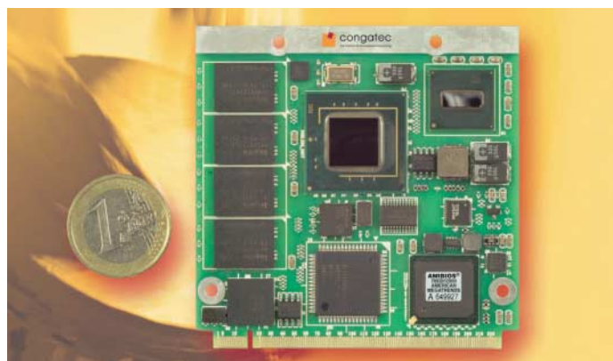
Einplatinen-Computer nach der Qseven-Spezifikation verzichten auf Legacy-Schnittstellen wie PCI und IDE. Dafür gibt es über spezielle MCM-Stecker moderne serielle Ports satt.
