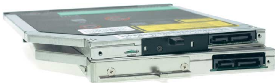
Neue SlimLine-Laufwerke haben den Micro-SATA-Anschluss, der auch an 1,8-Zoll-Platten mit SATA zum Einsatz kommt. Die von größeren Platten bekannte SATA-Buchse wäre zu breit.
