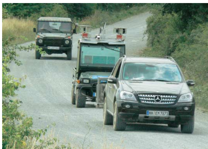
Bei der 20 Kilometer langen Konvoifahrt folgte RTS-Hanna von der Universität Hannover (Mitte) autonom dem Führungsfahrzeug bis zum Ziel.
