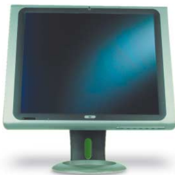
Das Touchscreen-Display des Panel-PC AFL-19B kann man dank IP64-Schutz getrost auch mit nassen Fingern bedienen.
