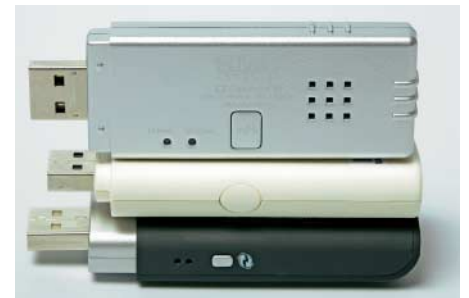
Automatische Konfiguration per Knopfdruck: Mit dem Taster kann man bei Hercules, Sitecom und SMC das Übertragen der WLAN-Einstellungen mittels WPS-PBC direkt am Stick auslösen.
