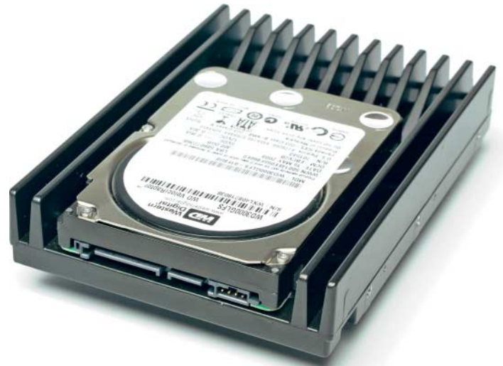
Damit Western Digitals 2,5"-High-End-Platte VelociRaptor auch in 3,5"-Einbauschächte passt, schraubt der Hersteller sie in einen Einbaurahmen, der gleichzeitig als Kühlkörper dient.
