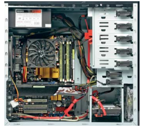
Die GeForce-GTX-280-Grafikkarte in dem PC von Kiebel kann bei einigen Spielen der CPU Physikberechnungen abnehmen.
