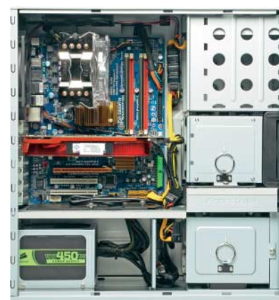
Unter der bunten Haube des UltraForce-Rechners steckt ein auf 3,6 GHz übertakteter Prozessor, den ein großer Kühler mit 12-cm-Lüfter im Zaum hält.
