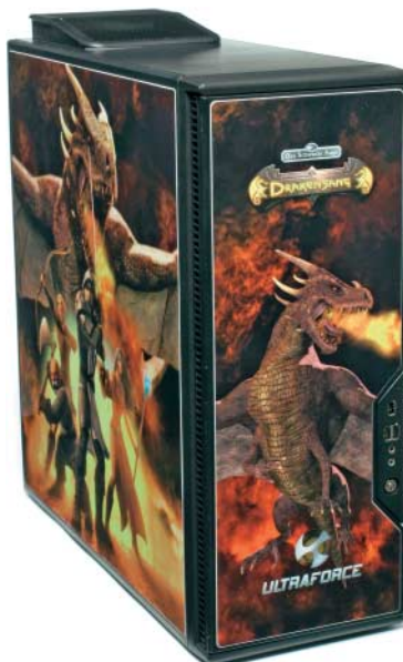
Unter der bunten Haube des UltraForce-Rechners steckt ein auf 3,6 GHz übertakteter Prozessor, den ein großer Kühler mit 12-cm-Lüfter im Zaum hält.
