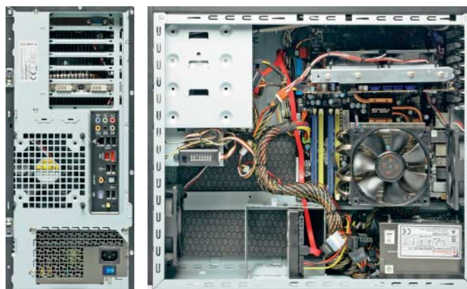
Unter der Last des Heatpipe-Kühlers und der zwei 80-mm-Lüfter verbiegt sich die Grafikkarte im PC von QuietSmart.
