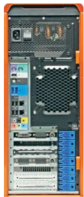
Trotz über 400 Watt elektrischer Leistungsaufnahme kommt Acer beim Aspire G7700 Predator mit wenigen Lüftern aus.
