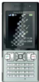
Das nur zehn Millimeter dicke T700 von Sony Ericsson eignet sich mit HSDPA und EGPRS als schnelles Funkmodem.
