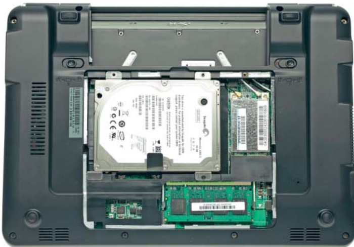
Gut zugänglich unter der Bodenklappe liegen die 2,5-Zoll-Festplatte und der Speicherriegel, daneben die WLAN-MiniCard.
