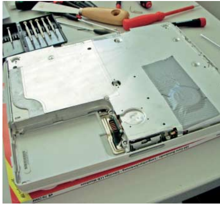
Eine dicke Unterlegscheibe wird mit Panzerband unter dem Grafikchip eines defekten iBook befestigt und drückt nach dem Zusammenbau auf die GPU.
