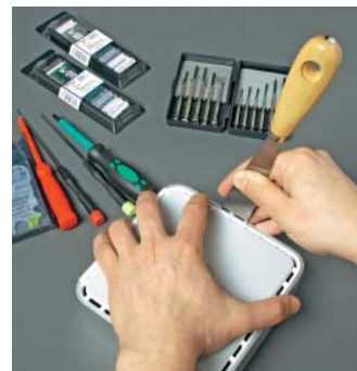
Das Gehäuse des Mac mini lässt sich mit einem angeschliffenen Spachtel öffnen.
