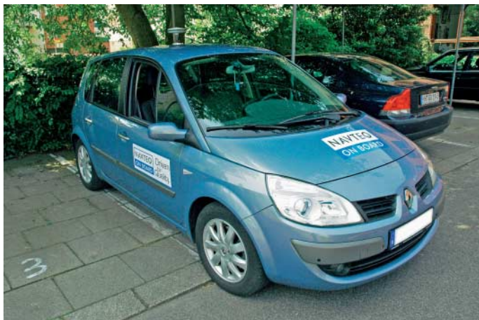
Für die Datenerfassung kommen Fahrzeuge (links Navteq, rechts Tele Atlas) mit Kameraaufbauten und zusätzlicher Bordelektronik zum Einsatz.
