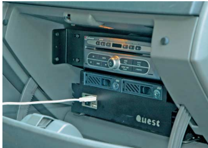
Die Fahrzeuge von Navteq (links) und Tele Atlas enthalten einen Differential-GPS-Empfänger und ein Gyroskop (Beschleunigungssensor) für die genaue Positionsbestimmung.
