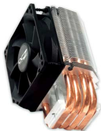
OCZ verzichtet beim Gladiator-Kühler auf eine Grundplatte, sodass die Heatpipes direkten Kontakt zum Prozessor haben.
