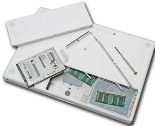
Die Festplatte und den Arbeitsspeicher des MacBooks kann man vom Akku-Fach aus erreichen und einfach tauschen.
