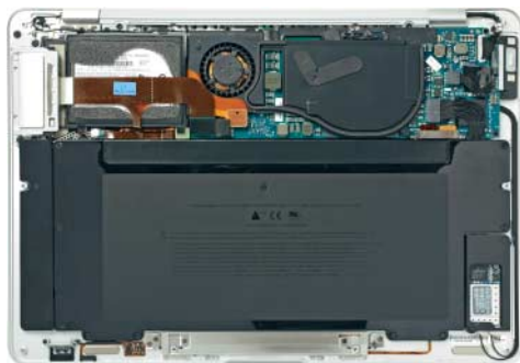
Beim MacBook Air ist die Hauptplatine (grün) deutlich kleiner als der unten angeordnete Akku (schwarz).
