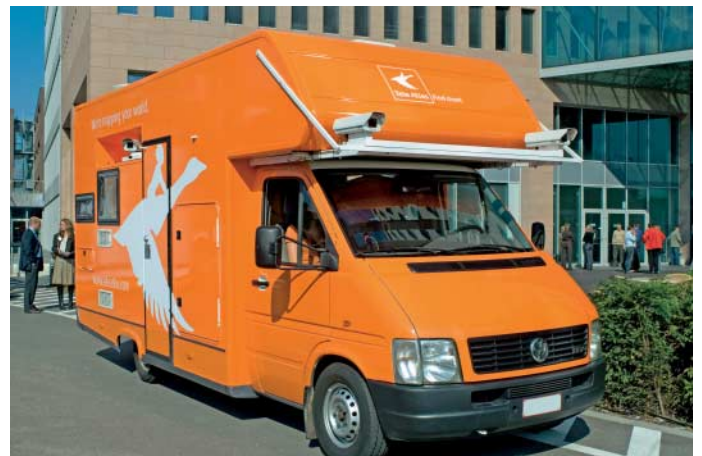
Für die Datenerfassung kommen Fahrzeuge (links Navteq, rechts Tele Atlas) mit Kameraaufbauten und zusätzlicher Bordelektronik zum Einsatz.
