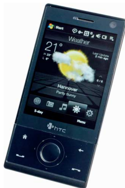
Das Display von HTCs Touch Diamond bietet mit 280 dpi eine extrem hohe Auflösung, zudem gefallen Details wie das Sensor-Jogdial. Die geringe Akkulaufzeit jedoch stört.
