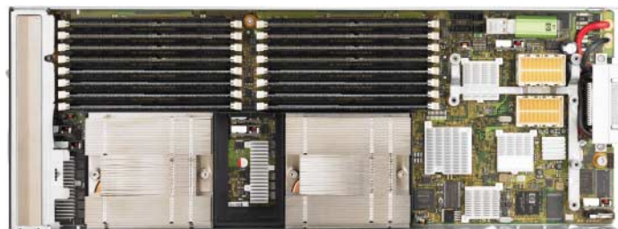
Selbst kompakte Blade-Server wie der HP ProLiant BL495c G5 fassen mittlerweile bis zu 128 GByte Hauptspeicher.
