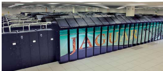
Der Jaguar-Rechner des Oak Ridge National Laboratory steht mit zwei getrennten Subsystemen in der Top500-Liste. Im neuen Cray XT5 sorgen über 150 000 Opteron-Kerne für die Petaflops-Rechenleistung.
